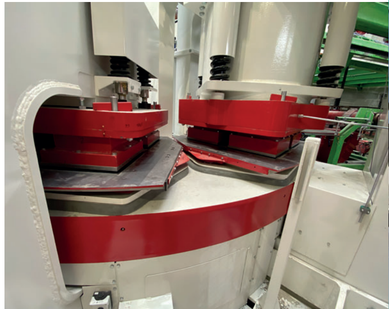
Abb. 3: Vor- und Hauptpressstation
