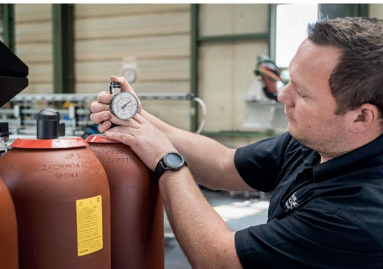
Prüfung des Blasenspeichers für konstante Leistung und sicheren Betrieb
