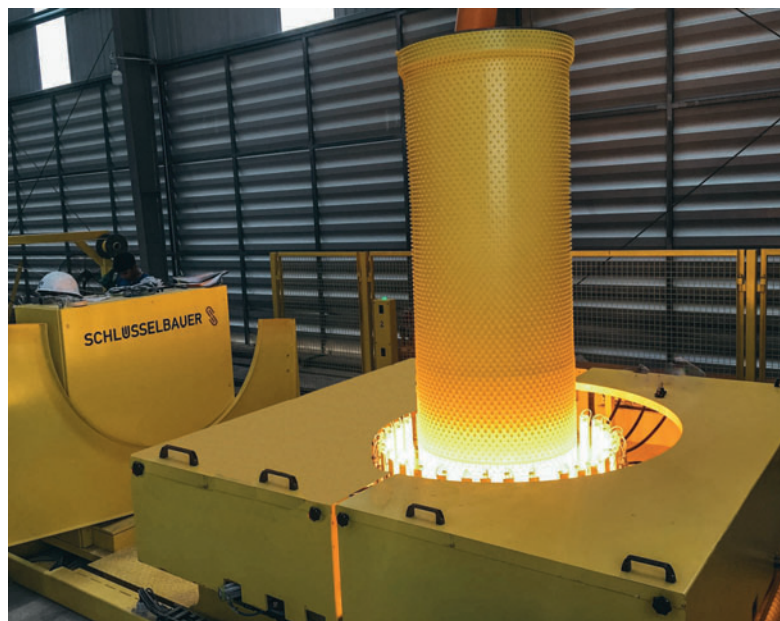
Die thermoplastische Umformung der Liner-Zylinder ist ein wesentlicher Schritt in der Herstellung von Perfect Pipe.
