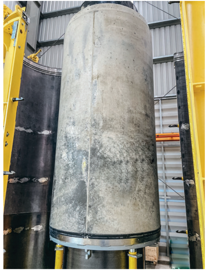
Perfect Jacking Pipe - schalungserhärtet nach wenigen Stunden in der Gießform
