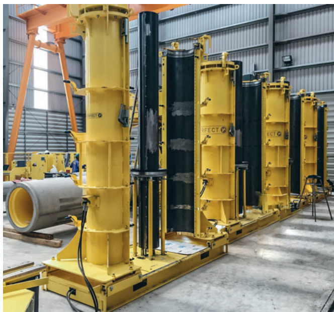
Anwenderfreundliche Formen der Kategorie Perfect Forming Technology von Schlüsselbauer in der Produktion bei Phnom Penh Precast, Kambodscha
