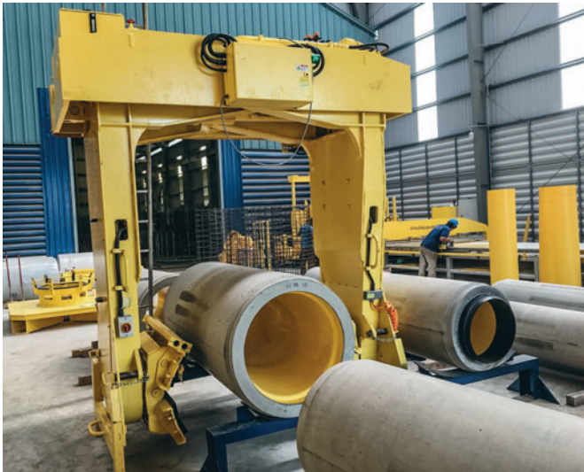
Phnom Penh Precast setzt die Perfect-Pipe-Technik aktuell im nichtbegehbaren Nennweitenbereich bis DN 700 ein.
