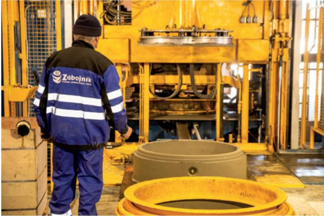
Кольца колодцев обычно изготавливаются в двух вариантах по толщине стенок и трех вариантах по высоте.
