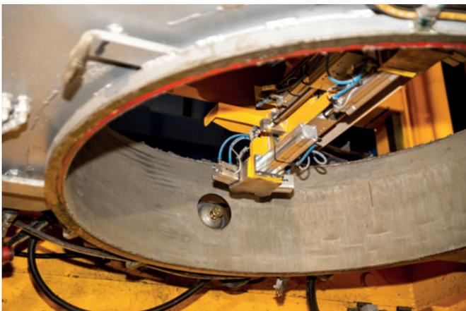
Решающий аспект автоматизации для компании Zábojník s.r.o.: автоматическая передача шаровых анкеров на формовочную установку. © Vojtěch Peša
