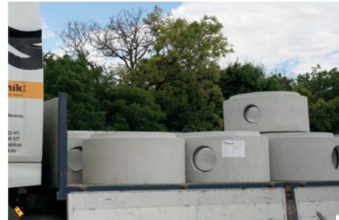
На втором предприятии компании изготавливаются монолитные кольца с дном по технологии Perfect с индивидуальными водоводами и встроенными уплотнениями
