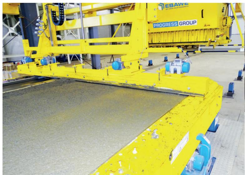
Виброрейка на бетонораздатчике снимает верхний слой бетонной смеси, заглаживает и уплотняет поверхность в соответствии с глубиной слоя бетона
