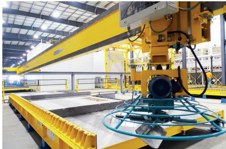
Для финишного заглаживания используется лопастная разравнивающая машина, в результате чего получается идеально гладкая бетонная поверхность, которая не требует последующей отделки
