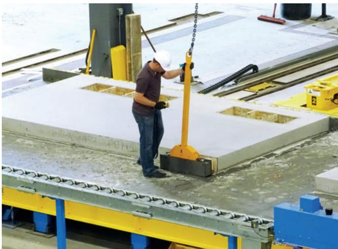
Опалубочный робот существенно повышает уровень автоматизации производства. Опалубка удаляется вручную с помощью траверсы
