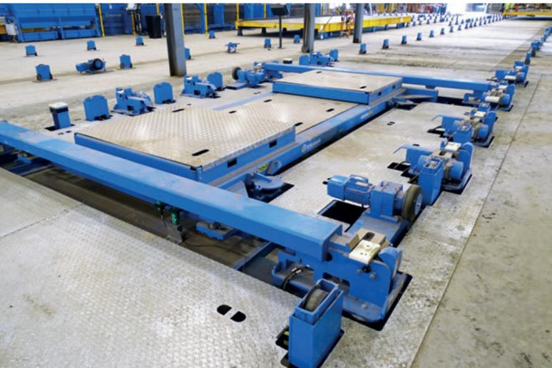
Комбинированное устройство виброуплотнения перемещает поддон в вертикальном и горизонтальном направлении, предлагая клиенту максимальную гибкость конечного продукта
