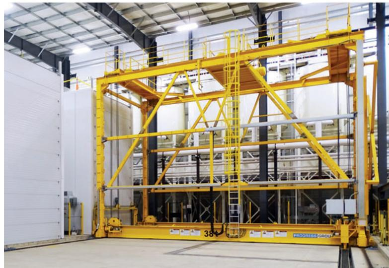
Подъемно-сдвижная платформа обслуживает две стеллажные стойки, отвечая за загрузку и выгрузку поддонов со свежеложенными и затвердевшими ж/б элементами
