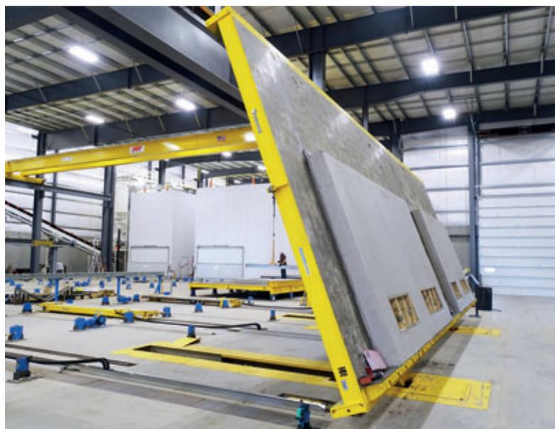
*Con l'ausilio del dispositivo di ribaltamento gli elementi per pareti vengono ribaltati e possono essere prelevati comodamente per quella che sarà la futura posizione di montaggio.*
