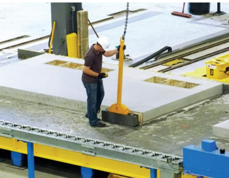
*Un robot di posizionamento fermagetti aumenta enormemente il livello di automazione della produzione. Le casseforme vengono prelevate a mano, grazie ad una traversa di movimentazione.*
