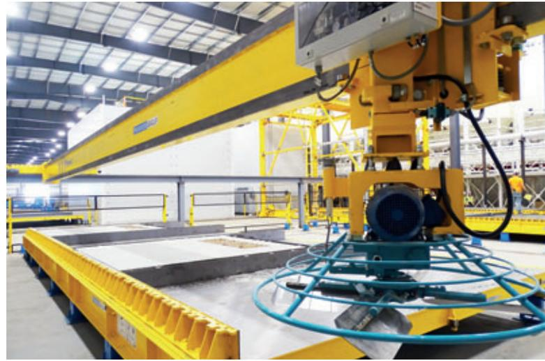
*Per la lisciatura fine si ricorre ad una lisciatrice: il risultato è una superficie del calcestruzzo molto ben liscata e verniciabile, che non richiede un post-trattamento.*
