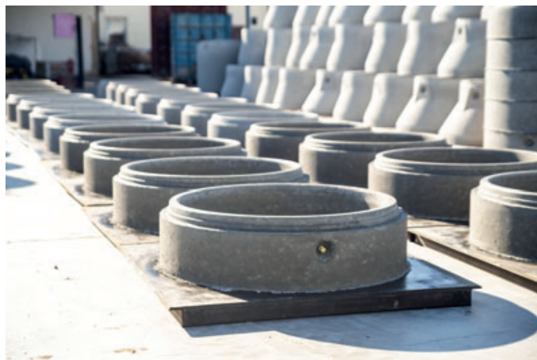
Le ancore a testa sferica sottoposte a vibrazione nel calcestruzzo costituiscono la base per una movimentazione sicura fino allo spostamento in cantiere. © Vojtěch Peša
