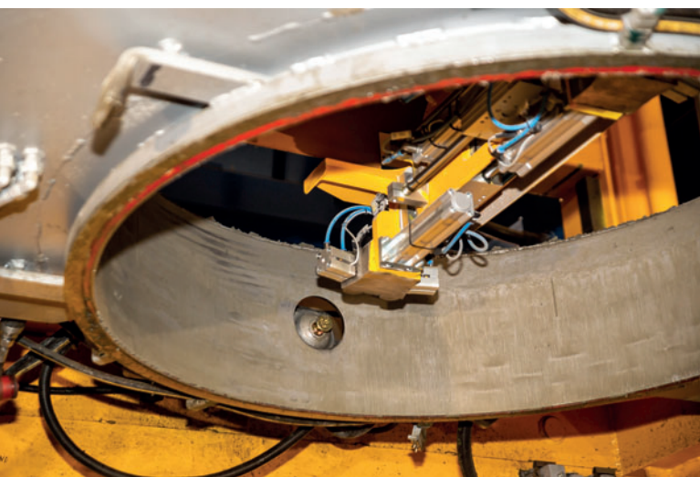
Un aspect décisif de l'automatisation pour Zábojník s.r.o. : le transfert jusqu'au moule des ancres à tête sphérique © Vojtěch Peša
