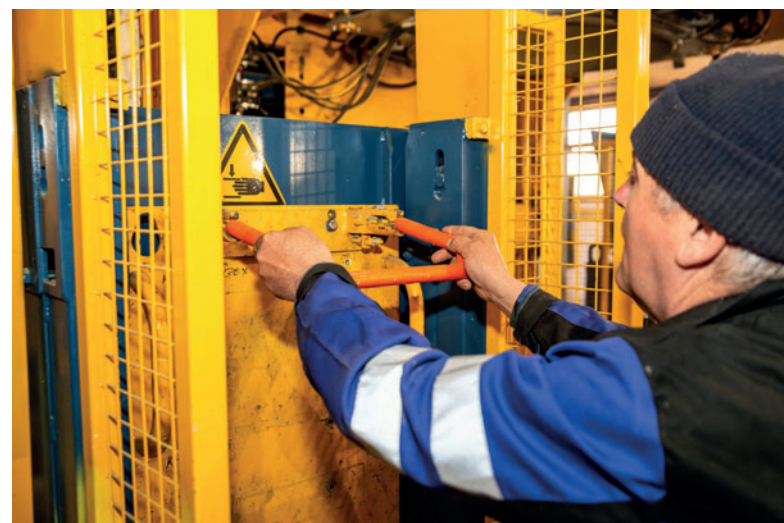
L'opérateur prépare le nombre d'échelons nécessaires pour transfert automatique à la machine de production. © Vojtěch Peša
