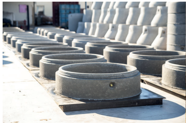
Les ancres à tête sphérique fixées dans le béton sont essentielles pour pouvoir manipuler les éléments en toute sécurité jusqu'au chantier. © Vojtěch Peša
