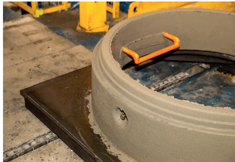
Outre les ancres de levage, des échelons sont également transférés à la machine pour être scellés automatiquement dans le produit béton, sans aucun impact sur la durée de cycle. © Vojtěch Peša
