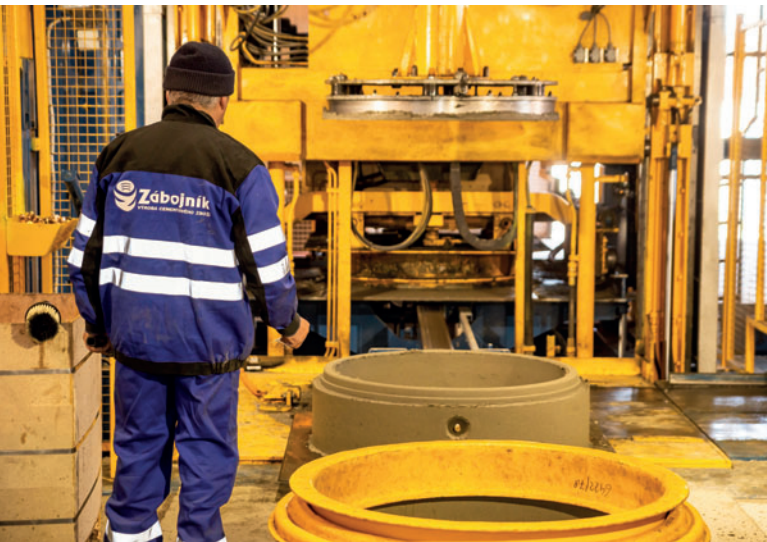
Les éléments de regards sont généralement fabriqués en deux épaisseurs de paroi différentes et sur trois hauteurs. © Vojtěch Peša
