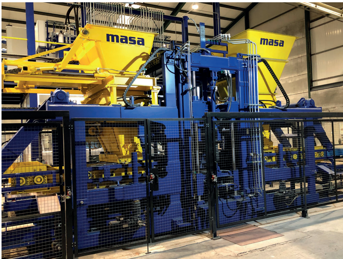
L'automate de production de blocs L 9.1 pour la fabrication de pavés avec et sans couche de parement
