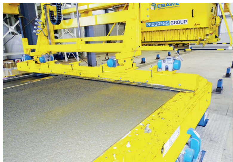
El travesaño oscilante montado en el distribuidor de hormigón nivela, alisa y compacta el hormigón en función de la profundidad de la capa de hormigón.
