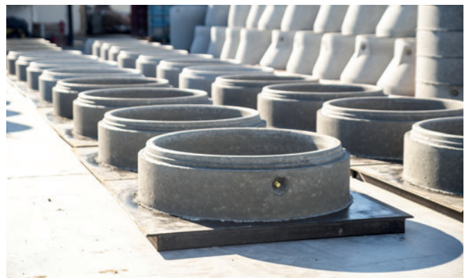
Los anclajes de cabezal esférico firmemente integrados en el hormigón constituyen la base para una manipulación segura hasta el traslado al lugar de obra. © Vojtěch Peša
