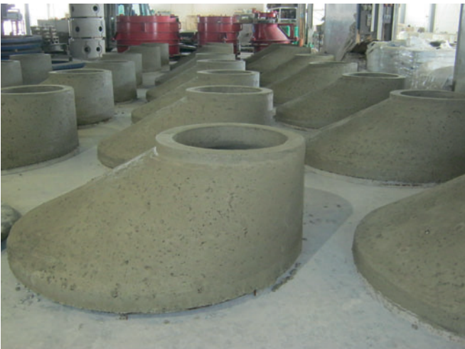
La nueva fabricación de anillos de pozo y conos en la Variant 2000 C se configuró según el mismo principio que la máquina anterior: cantidades intermedias con diámetros nominales de hasta 2000 mm y transporte de los productos en el revestimiento de molde hasta la estación de curado.
