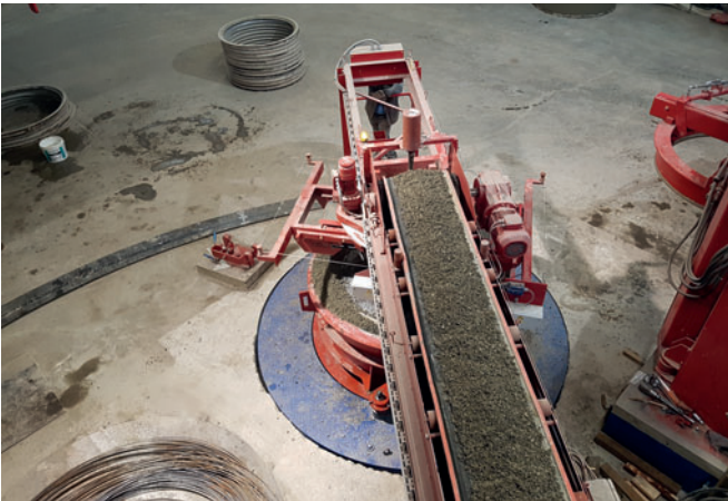
La Variant de Prinzing Pfeiffer es un concepto de máquina individualmente adaptable para la fabricación de tubos de hormigón armado (circulares y no circulares, con o sin base), tubos de revestimiento, tubos de hinca, elementos de marco, etc.
