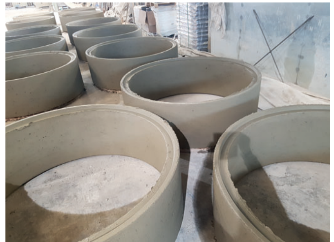
La nueva fabricación de anillos de pozo y conos en la Variant 2000 C se configuró según el mismo principio que la máquina anterior: cantidades intermedias con diámetros nominales de hasta 2000 mm y transporte de los productos en el revestimiento de molde hasta la estación de curado.
