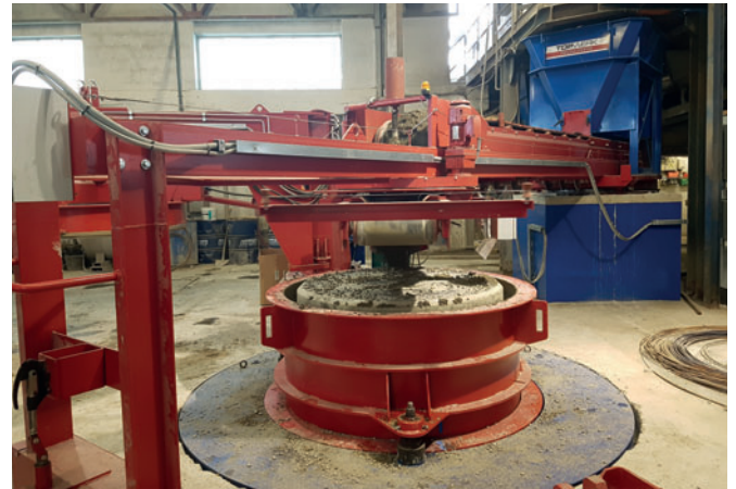
La Variant de Prinzing Pfeiffer es un concepto de máquina individualmente adaptable para la fabricación de tubos de hormigón armado (circulares y no circulares, con o sin base), tubos de revestimiento, tubos de hinca, elementos de marco, etc.
