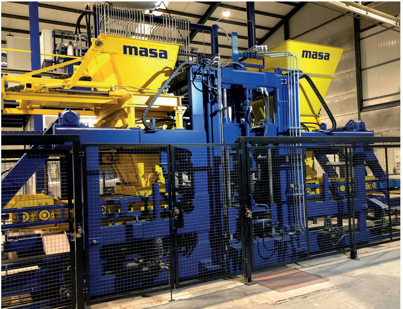
Máquina de fabricación de bloques L 9.1 para una óptima producción de adoquines.
