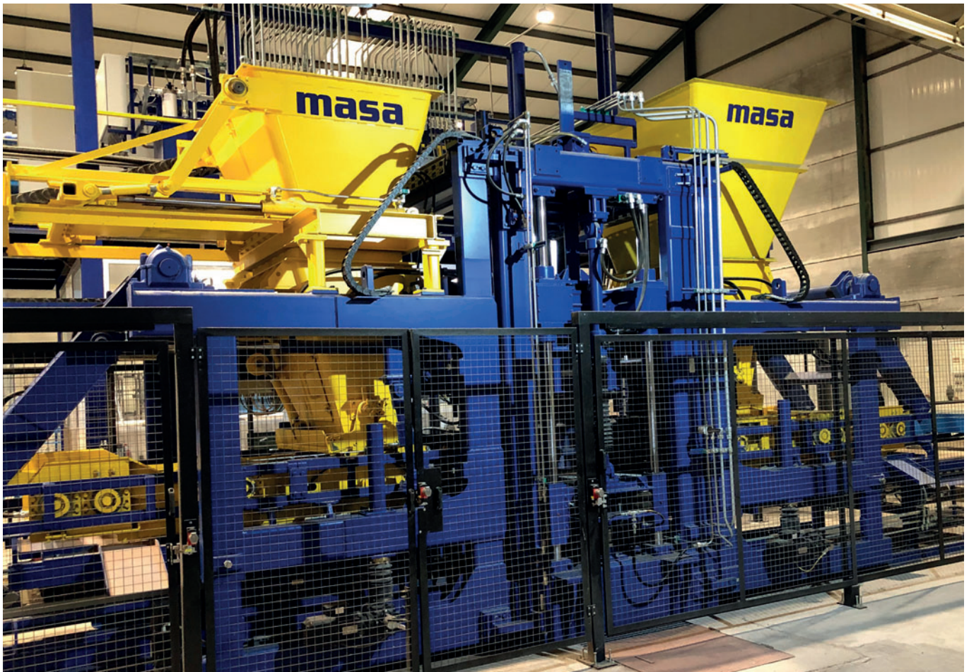
Vollautomatische Steinfertigungsmaschine L 9.1 zur Produktion von Betonsteinen mit und ohne Vorsatzschicht
