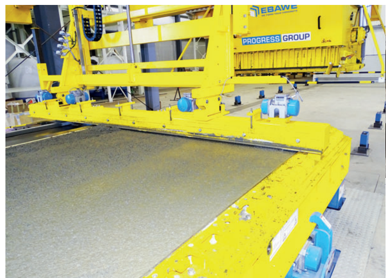
Die am Betonverteiler angebaute Glättbohle zieht den Beton ab, glättet und verdichtet ihn entsprechend der Betonschichttiefe.
