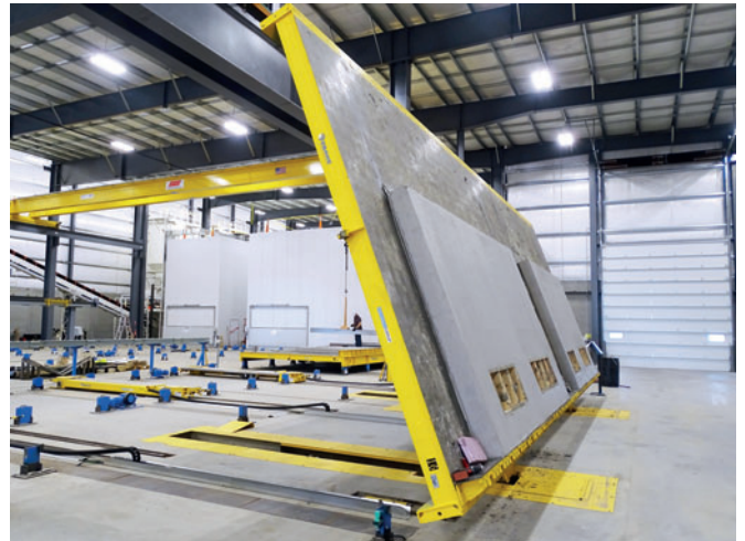
Mit Hilfe der Kippeinrichtung werden die Wandelemente gekippt und können komfortabel in der späteren Einbaulage entnommen werden.
