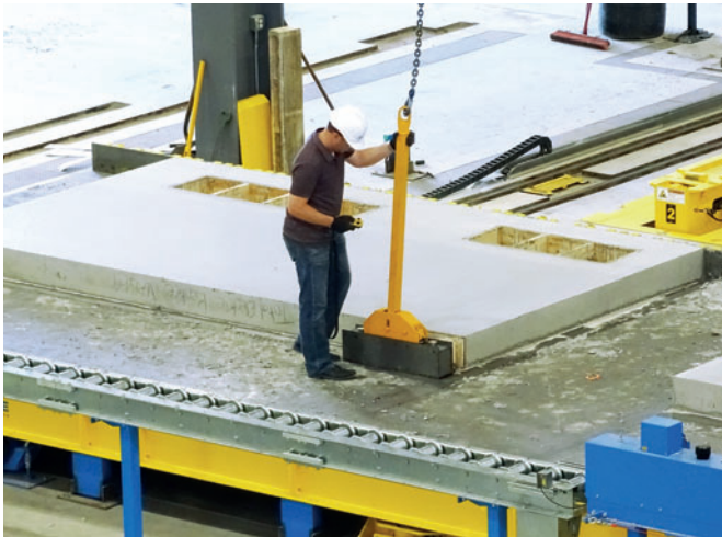
Ein Schalungsroboter erhöht den Automatisierungsgrad der Produktion enorm. Abgenommen werden die Schalungen händisch mit Hilfe einer Handlingstraverse.
