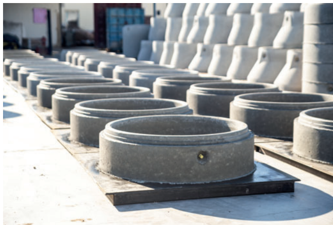
Die fest im Beton eingerüttelten Kugelkopfancker bilden die Grundlage für sicheres Handling bis zum Versetzen auf der Baustelle © Vojtěch Peša
