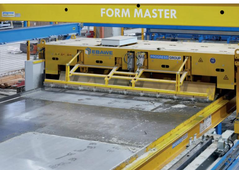
В новой системе циркуляции на заводе НТВ Hoch- und Tiefbaustoffe GmbH & Co. KG в Кеннерне поверхность поддонов оптимально очищается специальным устройством после распалубки
