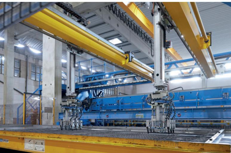
Производство опалубки на новом заводе по выпуску плит перекрытия и двойных стеновых панелей в Кеннерне также максимально автоматизировано. Роботизированный укладчик Wire Center устанавливает продольные и поперечные арматурные прутки, а также армокаркасы в опалубленные поддоны с помощью двух манипуляторов
