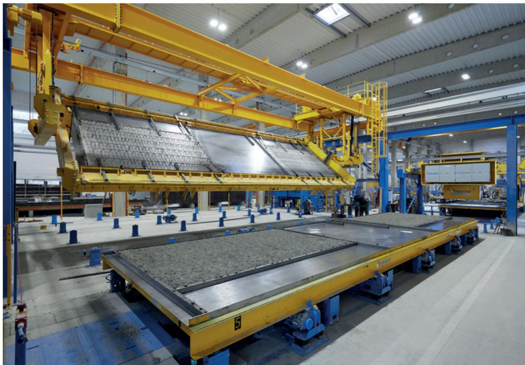
Для производства двойных стеновых панелей затвердевшую первую оболочку кантуют и укладывают поверх свежесбетонированной второй оболочки. Этот процесс осуществляется с помощью автоматического поворотного устройства
