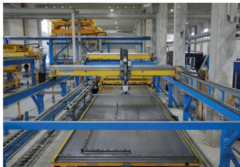
Комбинированный опалубочно-распалубочный робот компании progress Maschinen & Automation работает с системой опалубки Infinity Line®, которая значительно снижает нагрузку на опалубку и позволяет изготавливать внешние кромки очень высокого качества
