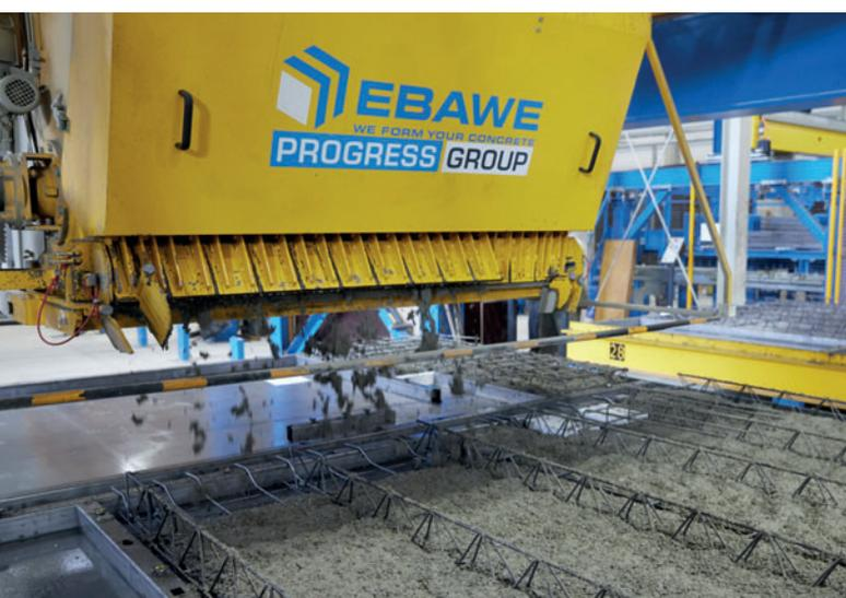
Новый бетонораздатчик Ebaawe в полностью автоматическом режиме выполняет процесс бетонирования плит перекрытия и двойных стеновых элементов
