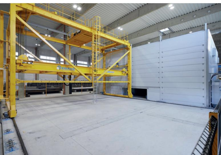
Стеллажный штабелер вмещает 36 поддонов и обслуживается подъемно-сдвижной платформой
