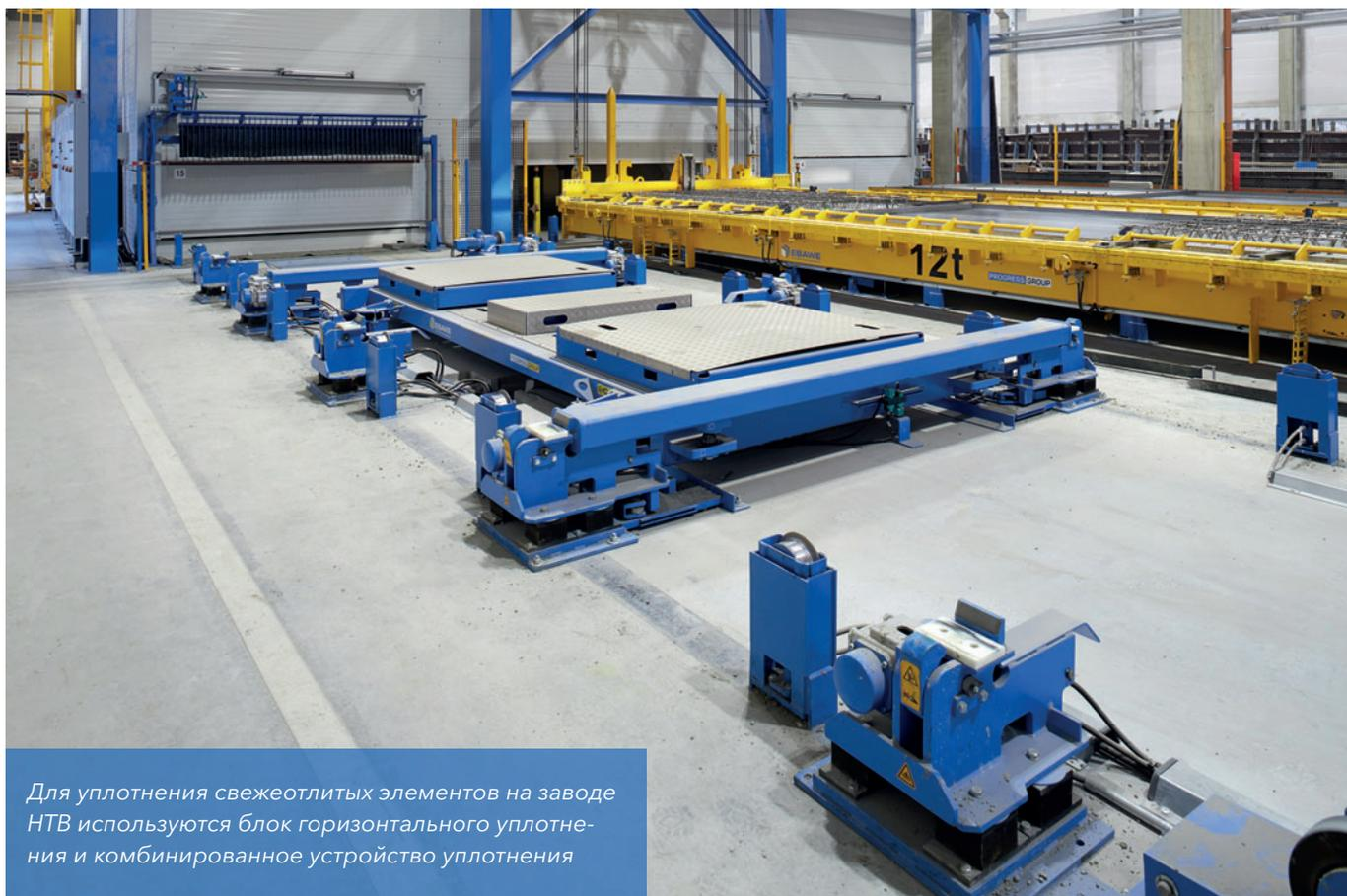
Для уплотнения свежечелитых элементов на заводе НТВ используются блок горизонтального уплотнения и комбинированное устройство уплотнения
