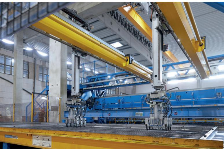
Anche l'armatura è stata notevolmente automatizzata nel nuovo stabilimento di pareti doppie e solai a lastre predalles di Könnern. Il robot di posa Wire Center inserisce nei pallet casserati sia barre longitudinale e trasversali sia tralicci con due bracci.
