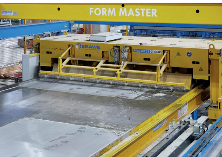
*Alla HTB Hoch- und Tiefbaustoffe GmbH & Co. KG di Könnern nel nuovo impianto a carosello la superficie dei pallet dopo il disarmo viene pulita in modo ottimale con il dispositivo di pulizia pallet.*
