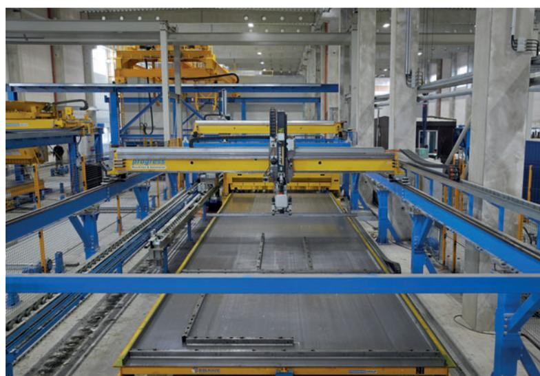
*Il robot di casseratura e disarmo combinato della progress Macchinari & Automazione lavora con il sistema di casseratura Infinity Line®, cosa che consente di ridurre notevolmente il lavoro di casseratura e di produrre bordi esterni di altissima qualità.*
