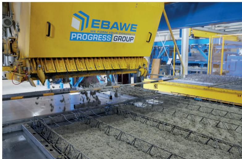
Il nuovo distributore di calcestruzzo di Ebawe si occupa del betonaggio completamente automatico degli solai a lastre predalles e pareti doppie.
