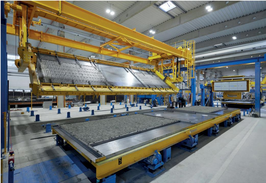
*Per produrre le pareti doppie si provvede a voltare il primo guscio maturato e lo si deposita sul secondo guscio appena betonato. Questo processo è realizzato con un dispositivo voltepezzi automatico.*
