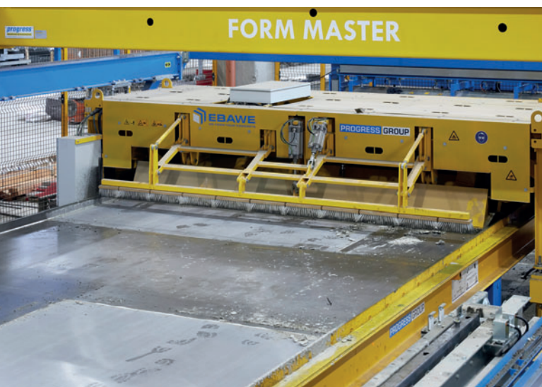
En la nueva instalación de circulación de HTB Hoch- und Tiefbaustoffe GmbH & Co, KG en Könnern, las superficies de las bandejas se limpian de forma óptima con el limpiador de bandejas tras el desencofrado.
