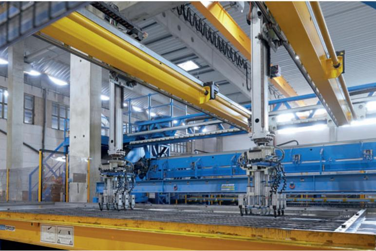
*Auch die Bewehrung wurde im neuen Doppelwand- und Elementdeckenwerk in Könnern weitestgehend automatisiert. Der Verlegeroboter Wire Center setzt sowohl Längs- und Querstäbe als auch die Gitterträger mit zwei Roboterarmen in die geschalteten Paletten.*
