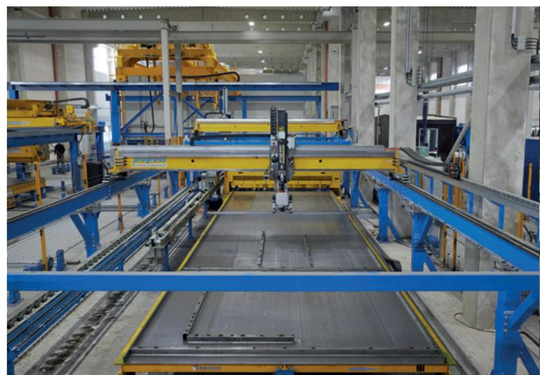
*Der kombinierte Schal- und Entschalroboter von progress Maschinen & Automation arbeitet mit dem Schalungssystem Infinity Line®, wodurch der Schalungsaufwand deutlich reduziert wird und Außenkanten von sehr hoher Qualität hergestellt werden können.*
