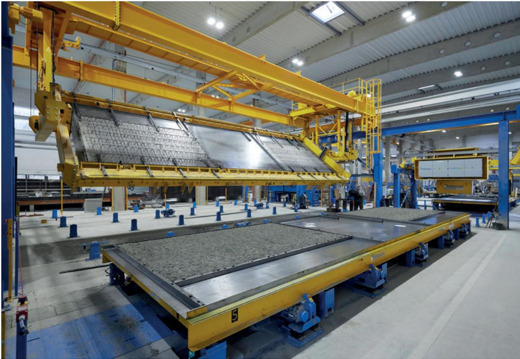
Zur Herstellung von Doppelwänden wird die ausgehärtete Erstschaale gewendet und über der frisch betonierten Zweitschaale abgesetzt. Dieser Prozess wird mit einer automatischen Wendeinrichtung realisiert.
