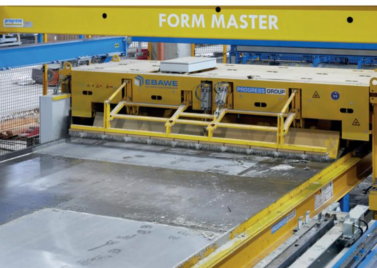
*In der neuen Umlaufanlage bei HTB Hoch- und Tiefbaustoffe GmbH & Co. KG in Könnern wird die Palettenoberfläche nach dem Entschalen durch den Palettenreiniger optimal gesäubert.*
