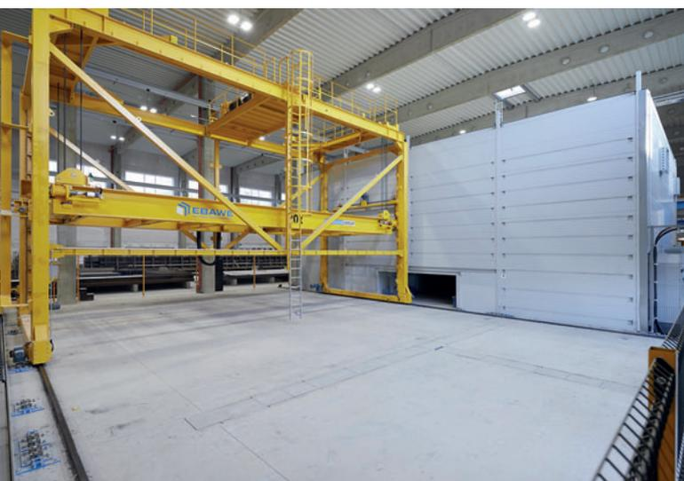
Das Stapelregal bietet Platz für 36 Paletten und wird über eine Hubschiebebühne bedient.
