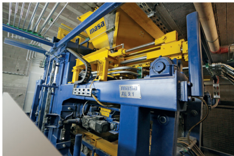
Испытанное устройство многоцветного окрашивания Masa интегрировано в бункер для бетонной смеси
