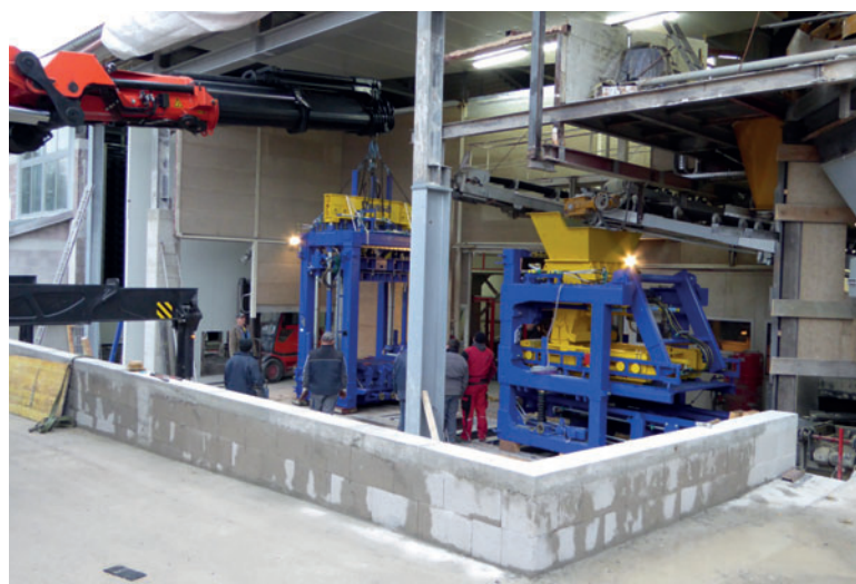
Монтаж блока уплотнения нового вибропресса Masa XL9.1
