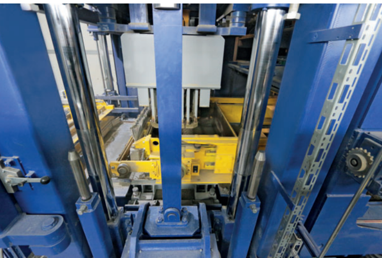
Изготовление нового блока: заполнение и уплотнение
