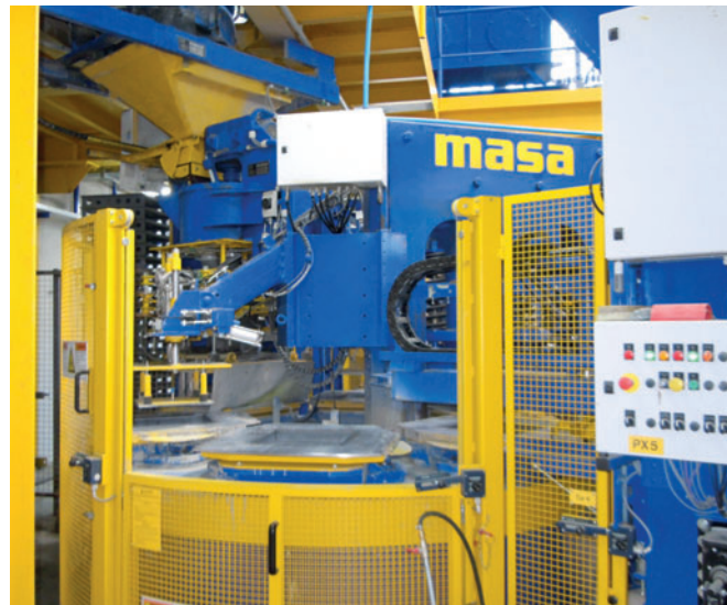
Раздатчик облицовочного бетона, система подачи опорного бетона и станция смены форм, а также защитный механизм с опускаемыми решетками
