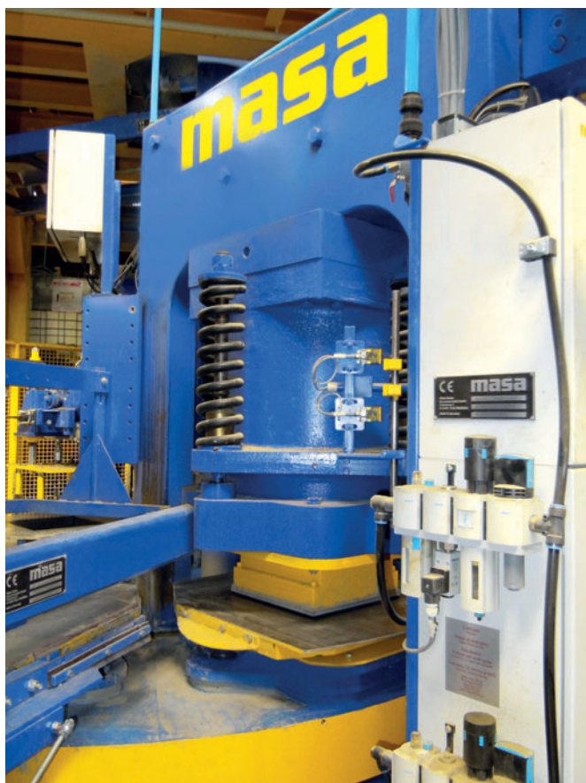
Станция главного прессования
