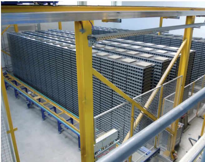
Склад плит с захватом для длинномерных грузов (до и после изоляции и монтажа камеры выдержки)
