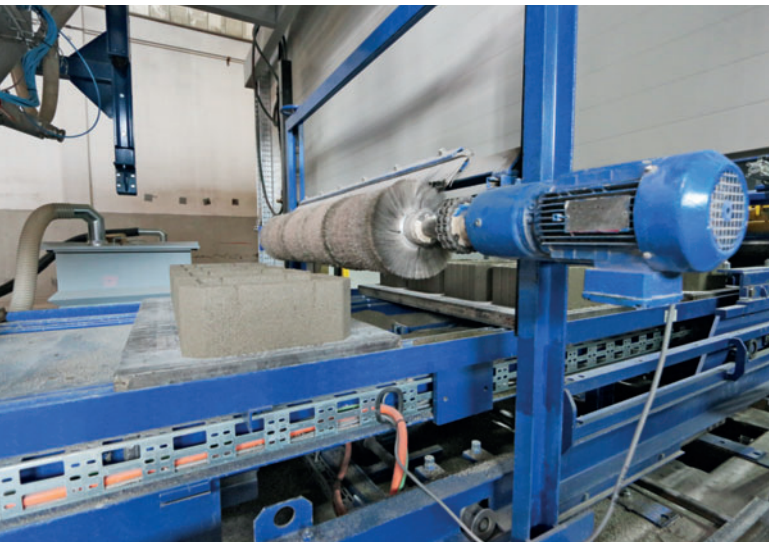
Транспортер на мокрой стороне производства для бережного перемещения изделий
