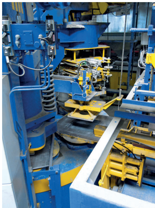
Станция выталкивания со съемником (на заднем плане шланговый дозатор)
