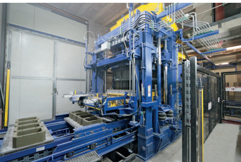
Качество и размерная точность: никаких проблем для нового вибропресса Masa XL 9.1
