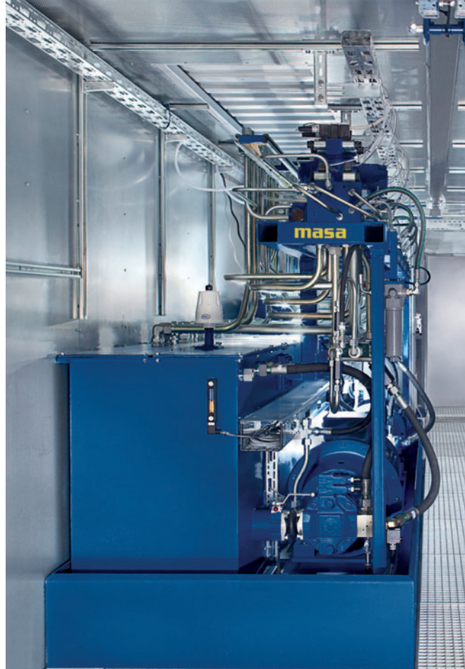
Все на своем месте: решение Masa Combitainer для комбинированного размещения гидравлического агрегата и электрошкафов
