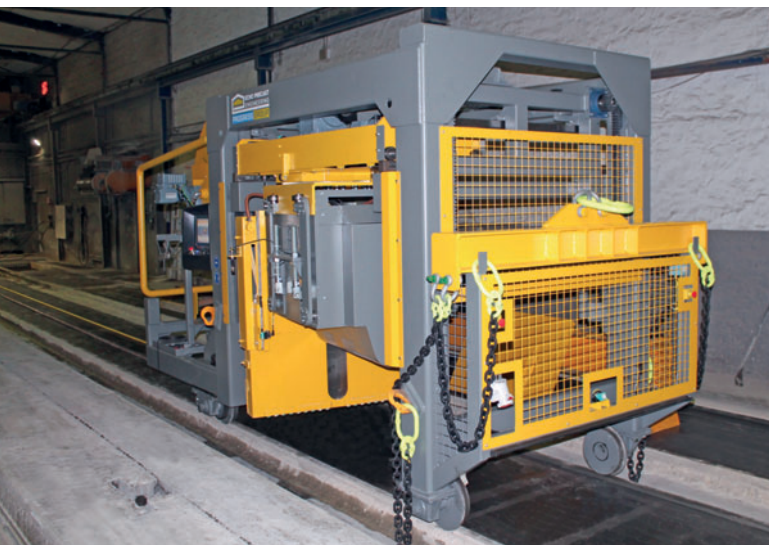
На заводе Dennert пила MAS 1100 фирмы Echo Precast обеспечивает более высокую степень автоматизации и эффективное производство преднапряженных сборных ж/б перекрытий (фото: Dennert)
