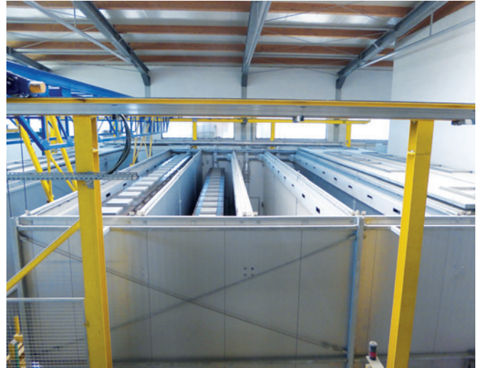
Magazyn podkładów z chwytakiem wyrobów podłużnych (przed i po późniejszym montażu izolacji oraz systemu dojrzewania wyrobów).
