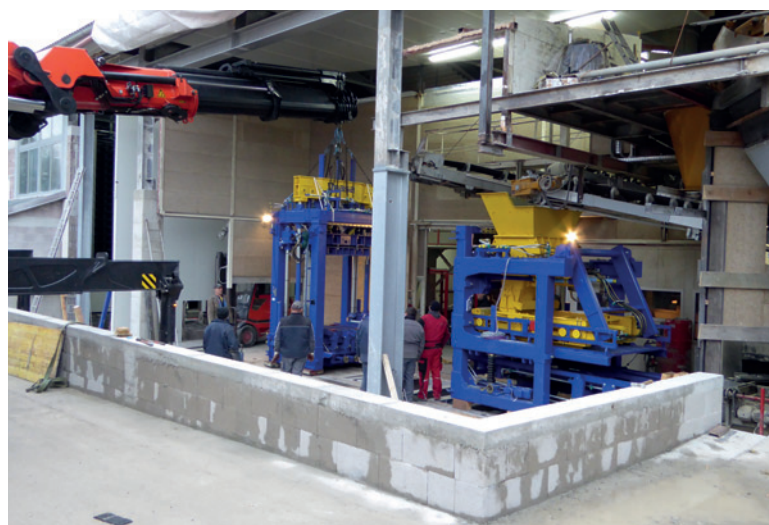
Montaż systemu wibrowania maszyny Masa XL9.1.
