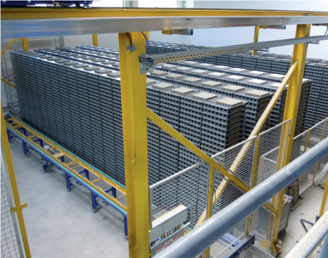
Magazyn podkładów z chwytakiem wyrobów podłużnych (przed i po późniejszym montażu izolacji oraz systemu dojrzewania wyrobów).
