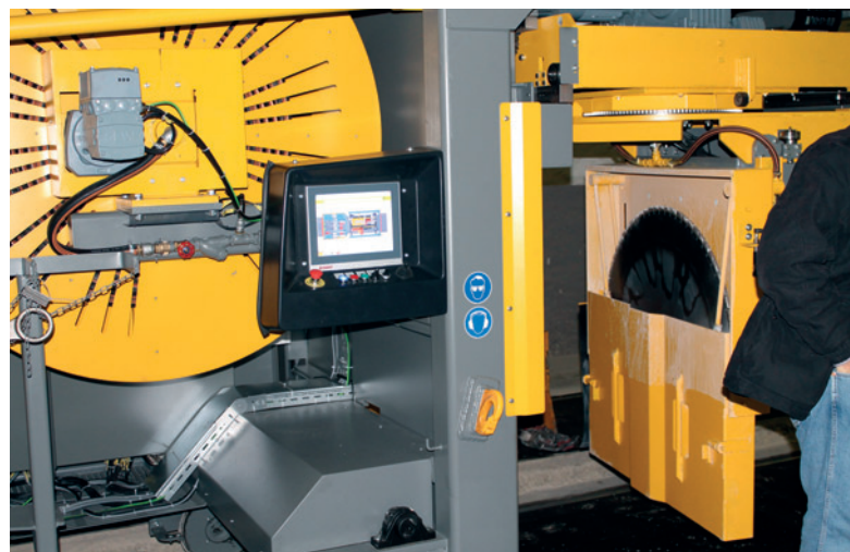
Piła do cięcia betonu pod różnymi kątami jest wyposażona w złącze internetowe i boczny panel dotykowy umożliwiający jej obsługę (fot. Dennert).
