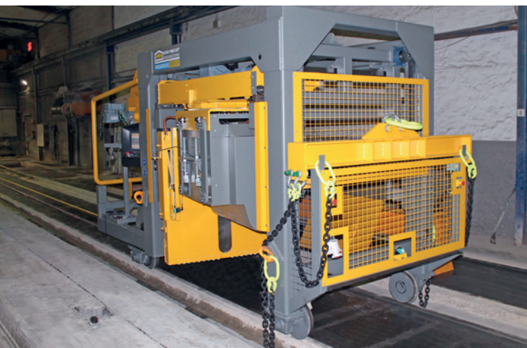
Piła MAS 1100 firmy Echo Precast zapewnia w zakładzie firmy Dennert wyższy poziom zautomatyzowania i większą wydajność w produkcji sprężonych płyt stropowych (fot. Dennert).
