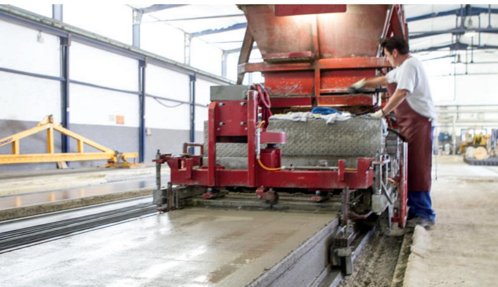
*Oltre alla macchina segatrice per gli elementi in calcestruzzo maturato, Dennert utilizza anche la vibrofinitrice S-Liner di Echo Precast Engineering su cinque linee di produzione (foto Dennert).*
