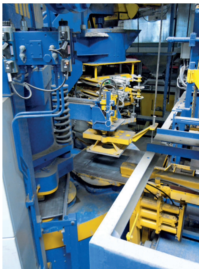
Stazione di espulsione con strumento di rimozione (sullo sfondo dosatore a tubi)
