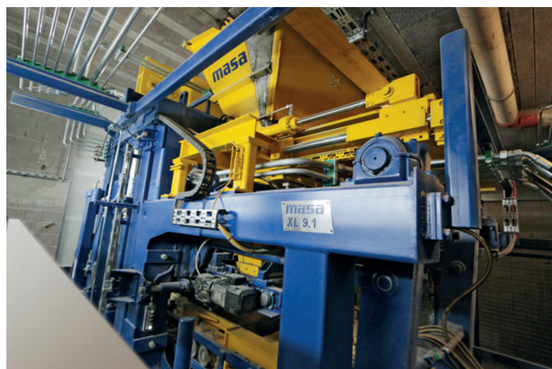
Integrato nel silo del calcestruzzo: il collaudato dispositivo Multicolor di Masa
