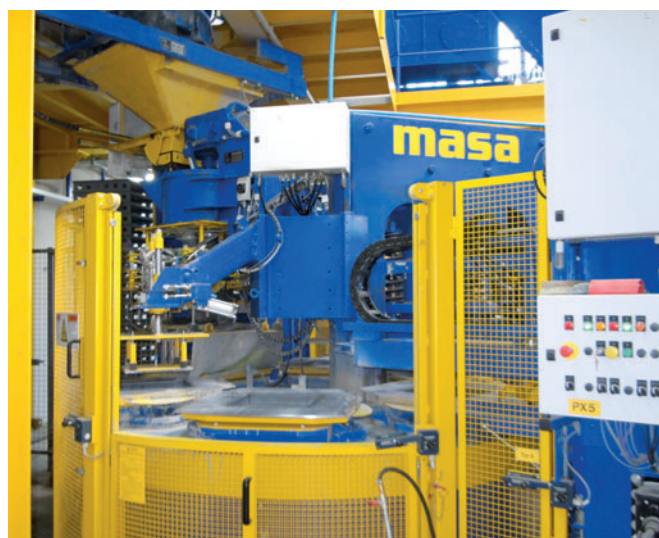
Distributore del calcestruzzo di rivestimento, alimentazione di quello per lo strato interno, stazione per il cambio degli stampi e sistema di sicurezza con griglie di protezione.
