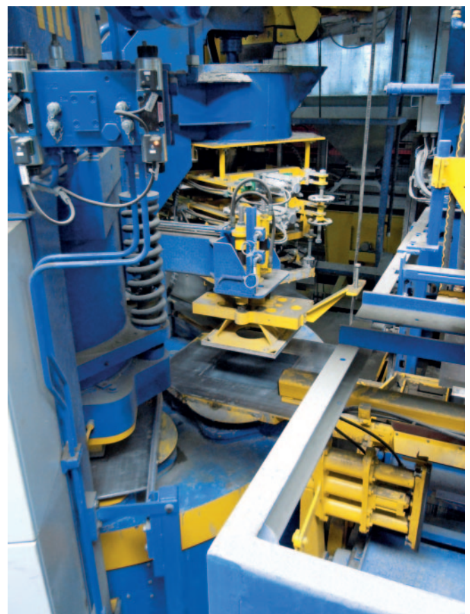
Station d'éjection avec dispositif de prélèvement (à l'arrière-plan du doseur à tuyau flexible)
