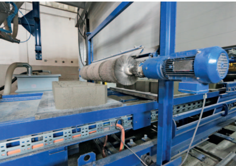
Transport délicat du produit avec le système, côté humide
