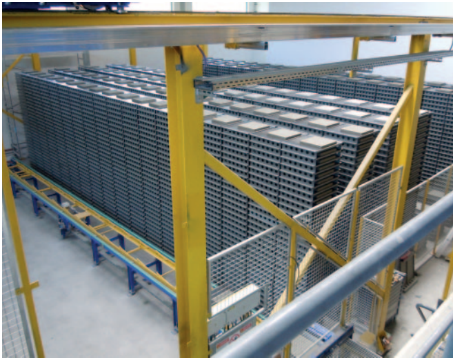
Entrepôt de palettes avec pince pour produits de grande longueur (avant et après l'enceinte ultérieure et l'installation du système de durcissement).
