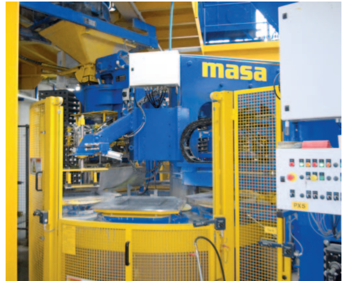
Distributeur de béton de parement, alimentation en béton de corps, station de changement de moule et grilles de protection abaissables (concept de sécurité).
