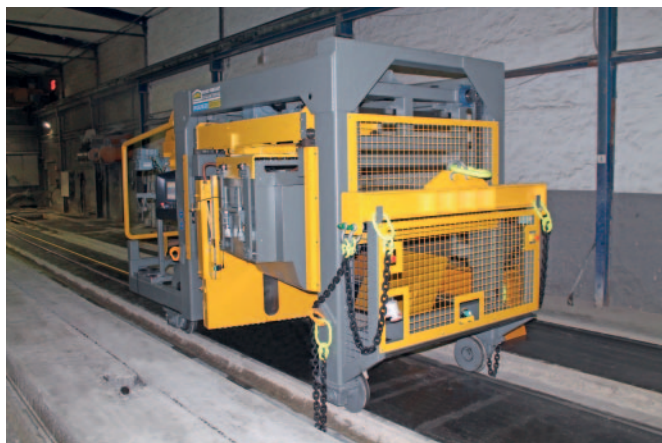
Grâce à la scie multi-angles MAS 1100 d'Echo Precast, Dennert dispose d'un degré d'automatisation plus élevé et d'une production plus efficace de dalles alvéolées (photo : Dennert).
