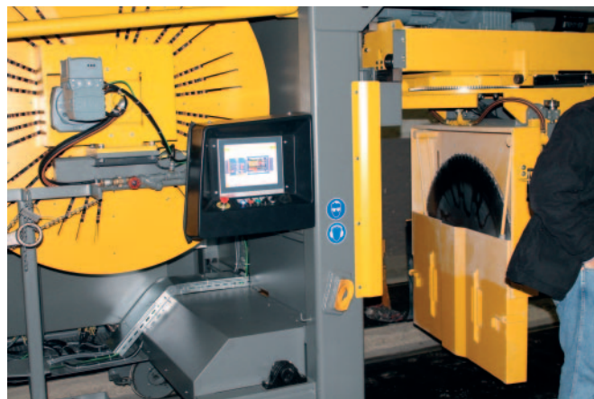
La machine est équipée d'une connexion Internet et d'un pavé tactile latéral de commande (photo : Dennert).
