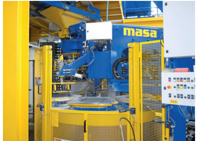
Distribuidor de hormigón bicapa, suministro de hormigón monocapa y estación de cambio de molde, así como concepto de seguridad con rejillas protectoras móviles.
