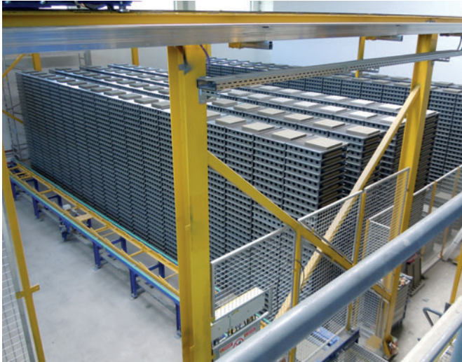
Almacén de bandejas con pinza para productos largos (antes y después de cerrar el recinto y de la instalación del sistema de curado.).
