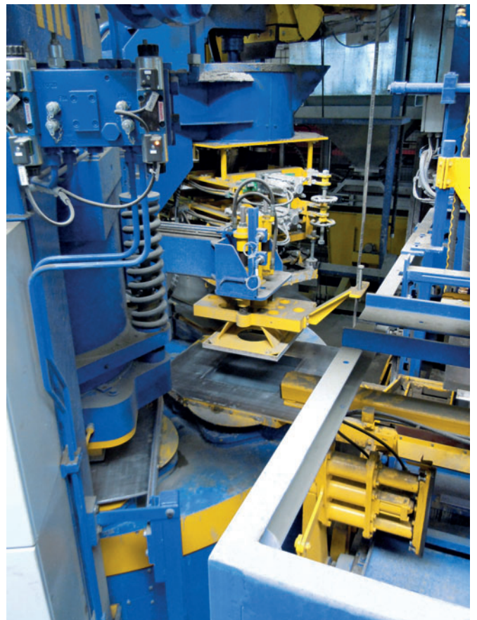
Estación de salida con equipo de carga (al fondo, dosificador de tubo)
