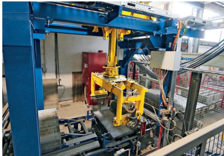
Con y sin giro vertical: el transferidor se adapta individualmente
