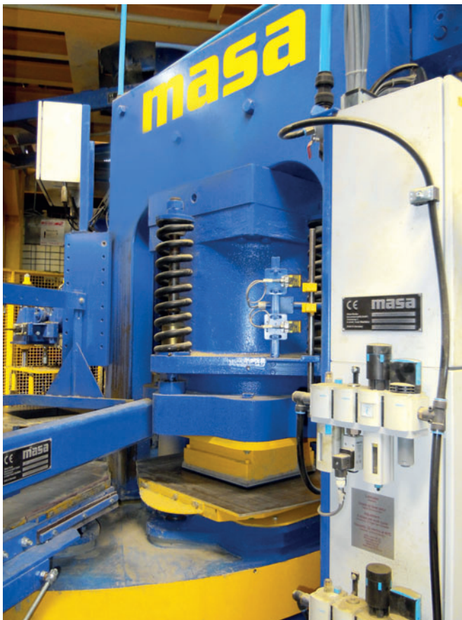
Estación de prensado principal
