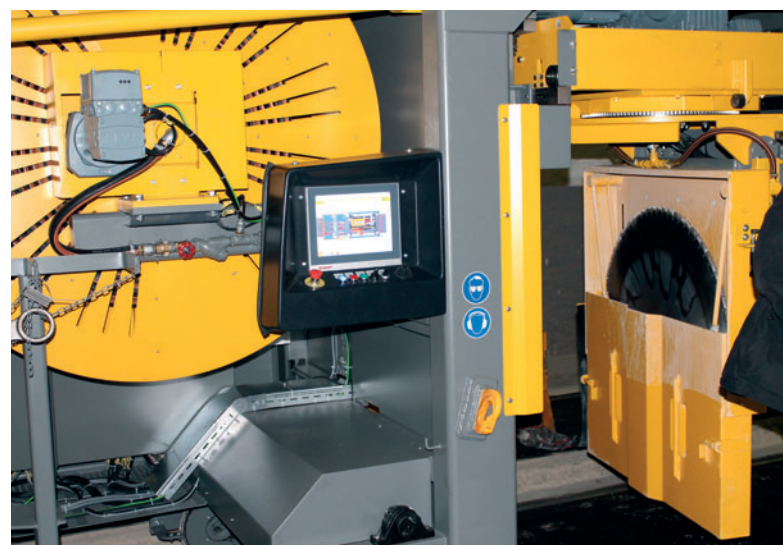
La sierra multiangular cuenta con una conexión a internet y un panel táctil externo para su operación (imagen: Dennert).
