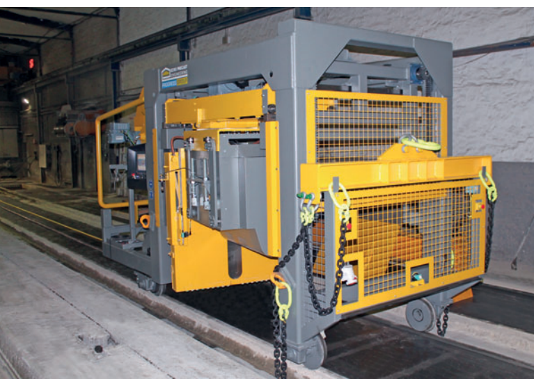
La MAS 1100 de Echo Precast proporciona a Dennert un mayor grado de automatización y una producción más eficiente de losas alveolares pretensadas (imagen: Dennert).
