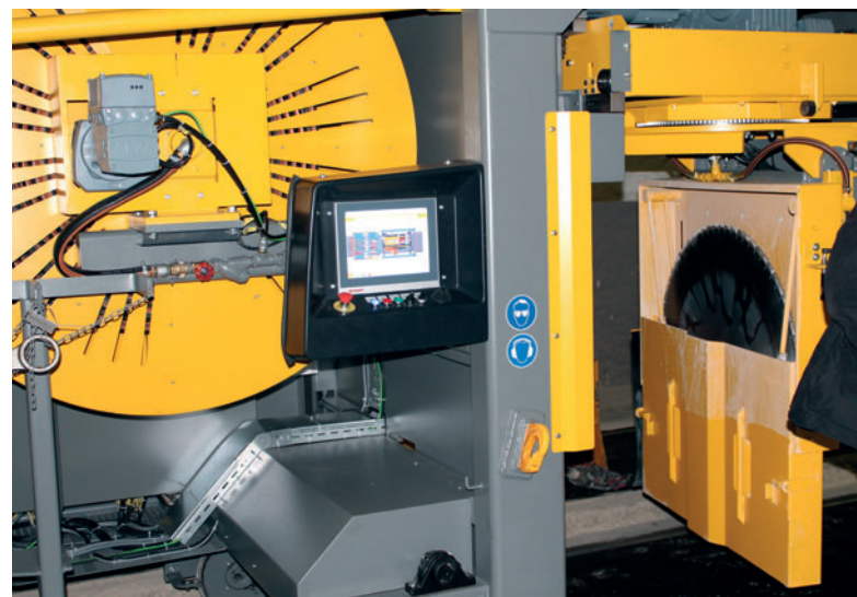
Die Mehrwinkelsägemaschine verfügt sowohl über einen Internetanschluss als auch über ein außenseitiges Bediener-Touchpad (Bild: Dennert).
