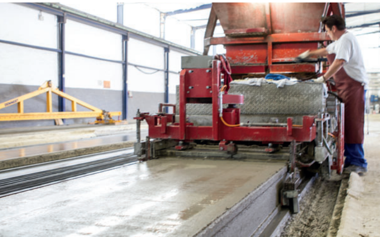
Neben der Säge für ausgehärtete Betonfertigteile nutzt Dennert den Gleitfertiger S-Liner von Echo Precast Engineering auf seinen fünf Produktionsbahnen (Bild: Dennert).
