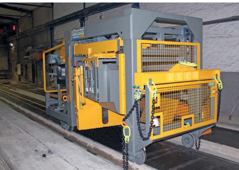
Die MAS 1100 von Echo Precast sorgt bei Dennert für einen höheren Automationsgrad und eine effizientere Produktion von Spannbeton-Fertigdecken (Bild: Dennert).
