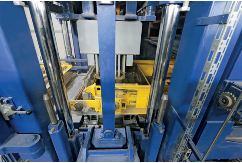
Ein neuer Mauerstein entsteht: Befüllen und Verdichten.
