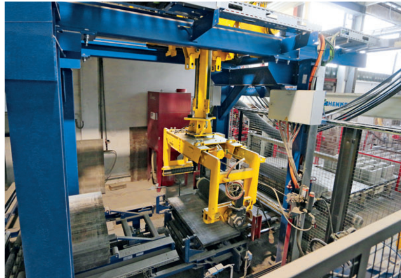
Mit und ohne Vertikaldrehung: Der Umsetzer passt sich individuell an.
