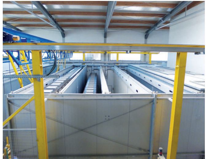
Palettenlager mit Langgutgreifer (vor und nach der späteren Einhausung und Installation des Aushärtungssystems)
