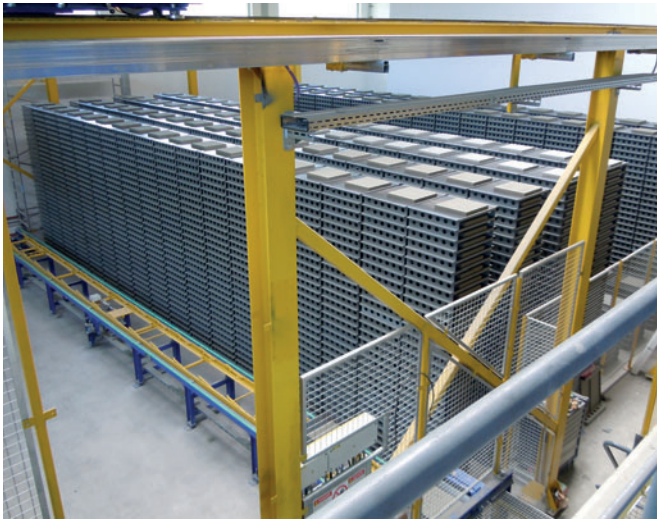
Palettenlager mit Langgutgreifer (vor und nach der späteren Einhausung und Installation des Aushärtungssystems)
