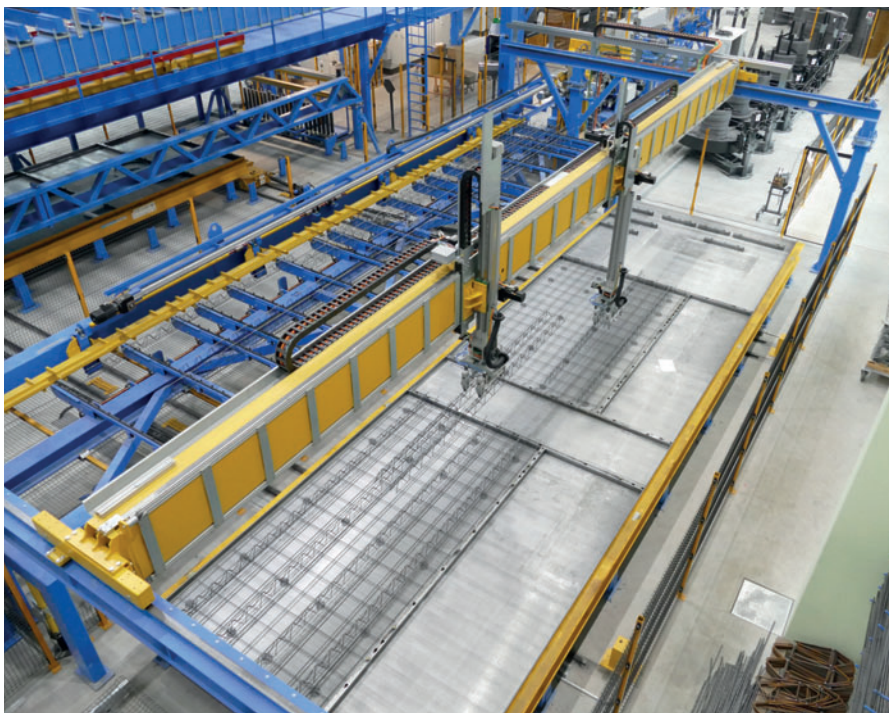
Многоосный линейный робот дополняет техническое оснащение автоматизированного арматурного участка на новом заводе компании Eder
