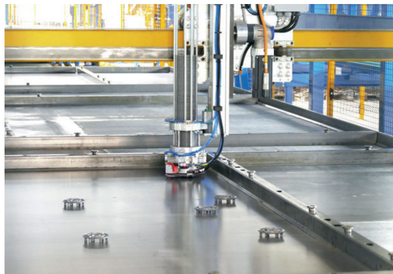
Полностью автоматическая укладка фиксаторов с помощью MeshSpacer позволяет компании Eder добиться существенной экономии
