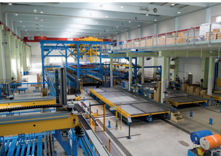
Новая высокоавтоматизированная циркуляционная линия на заводе Eder в Калльхаме
