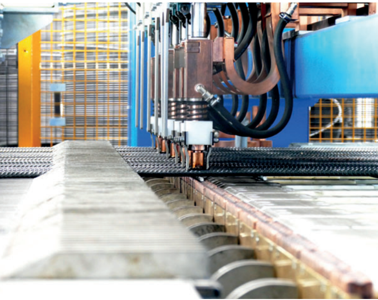
Производство арматурных сеток «точно в срок» на сеткосварочной установке BlueMesh фирмы progress Maschinen & Automation
