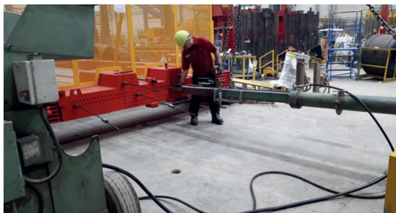
*Pista di precompressione universale auto-reagente di 34 m x 2,7 m, con una capacità di precompressione di 560 ton.*
