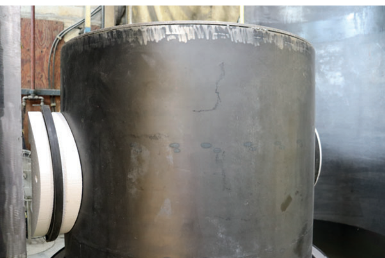
I negativi per i raccordi del tubo con la guarnizione integrata possono essere posizionati direttamente sul nucleo in acciaio dello stampo.
