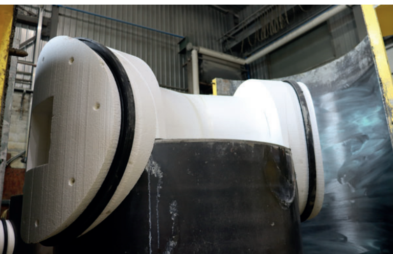
I negativi per i canali di scolo vengono fissati con una tecnologia a magneti.
