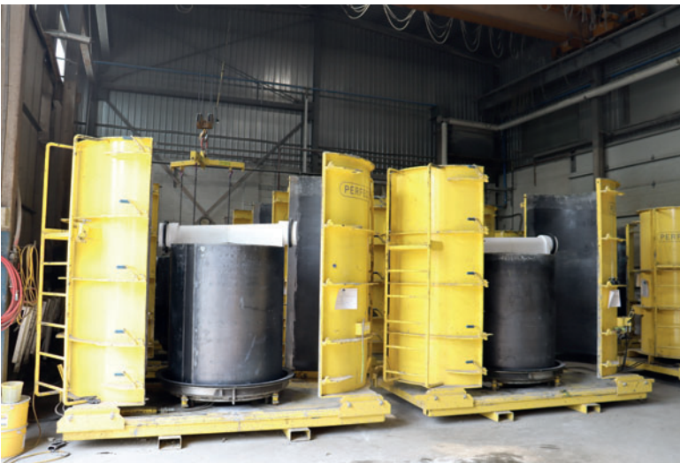
Gli stampi dispongono di un involucro composto da due parti e possono essere aperti in modo simmetrico.
