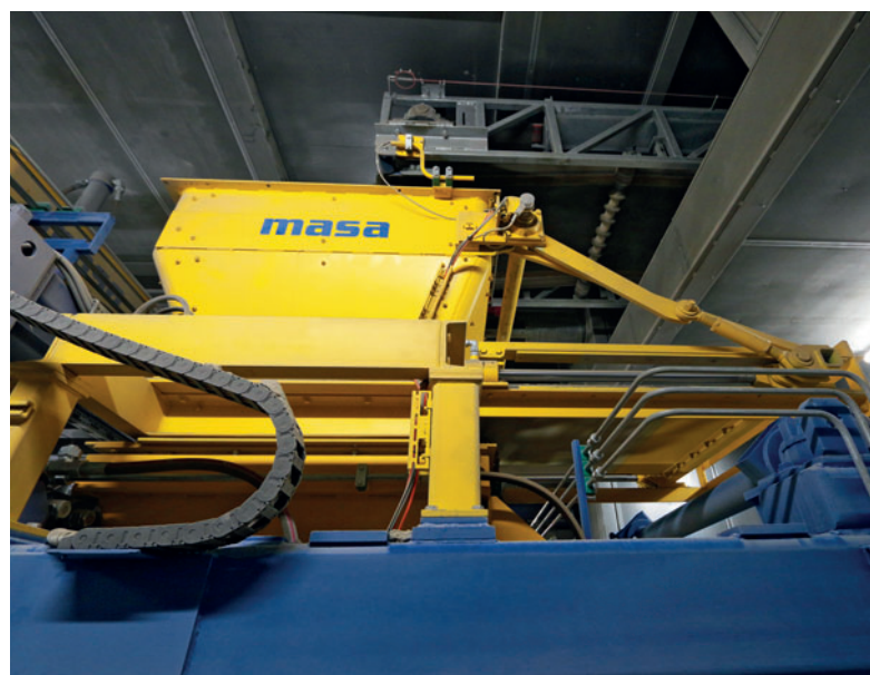
Dispositivo Multi Color con valvola a cassetto ad azionamento idraulico
