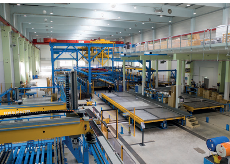
Uno sguardo al nuovo impianto a carosello altamente automatizzato alla Systembau Eder di Kallham
