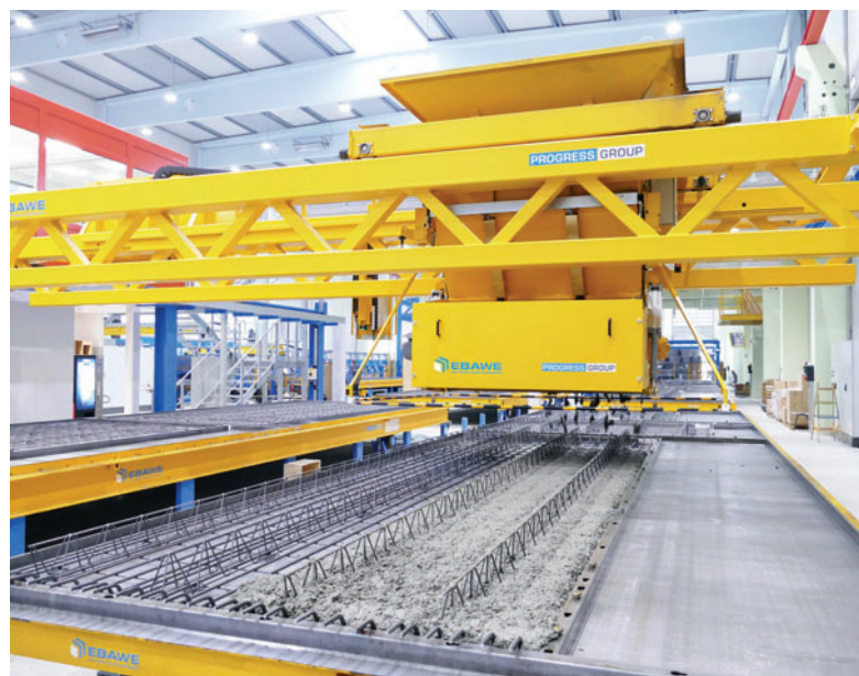
Elevata velocità di scarico, abbinata ad un'ottima dosabilità del calcestruzzo grazie al nuovo distributore automatico di calcestruzzo eCon® Drive
