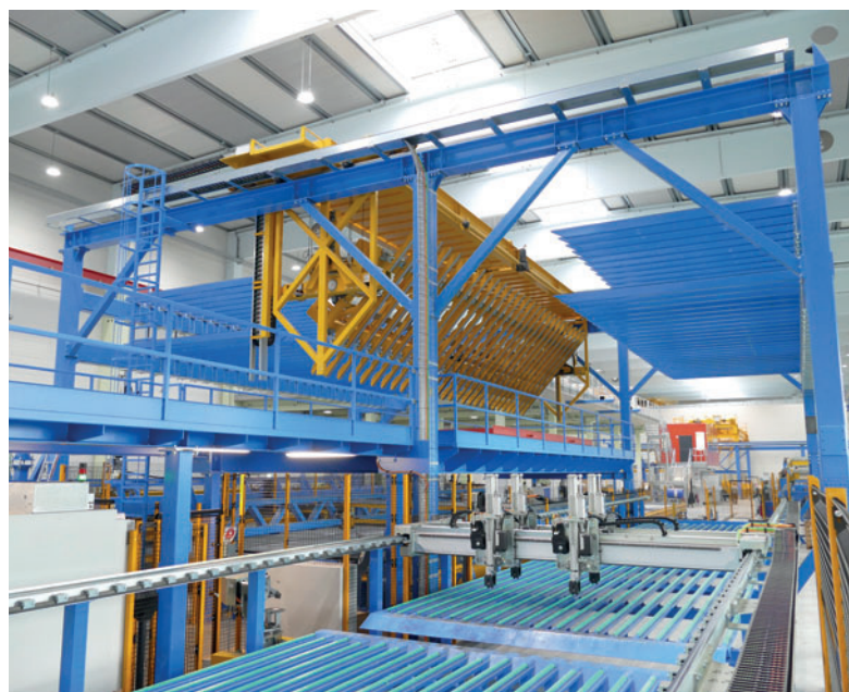
La traversa magnetica inserisce le reti nei pallet seguendo le istruzioni CAD, alimenta il deposito intermedio, è in grado di ribaltare le reti quando le barre longitudinali devono trovarsi sopra quelle trasversali e depositarle su un carrello impilatore.
