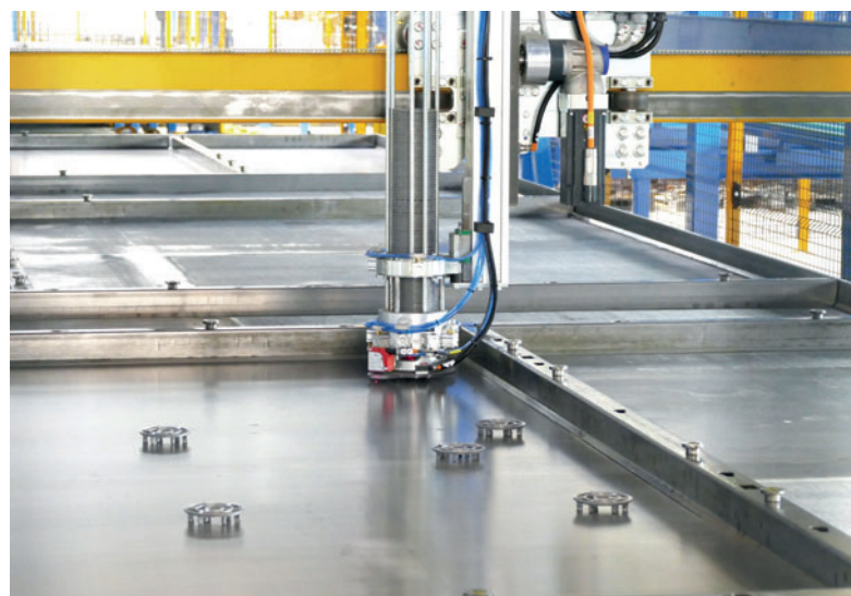
Grazie alla posa dei distanziatori completamente automatica con la MeshSpacer Eder realizza notevoli risparmi.
