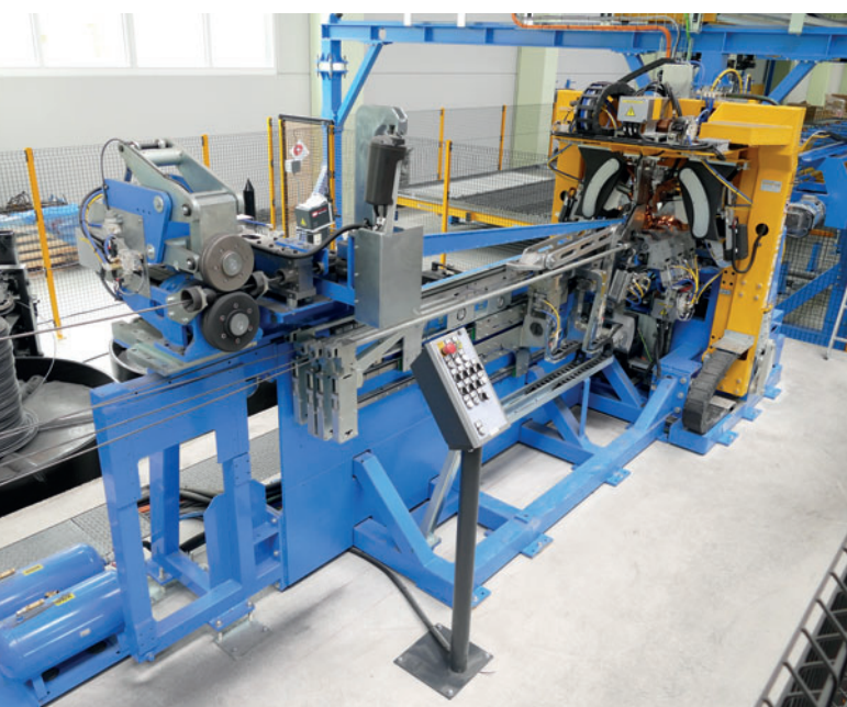
Grazie alla saldatrice di tralicci VGA Versa, i tralicci vengono prodotti "just in time", cio' consente a Eder di realizzare notevoli risparmi a livello di logistica e ridurre gli oneri di magazzino e gli scarti.
