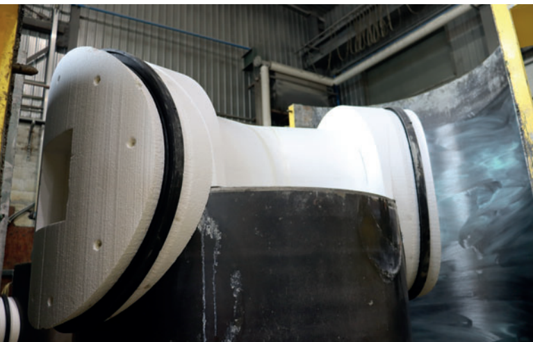
Les négatifs de cunettes sont maintenus dans le moule grâce à des aimants.
