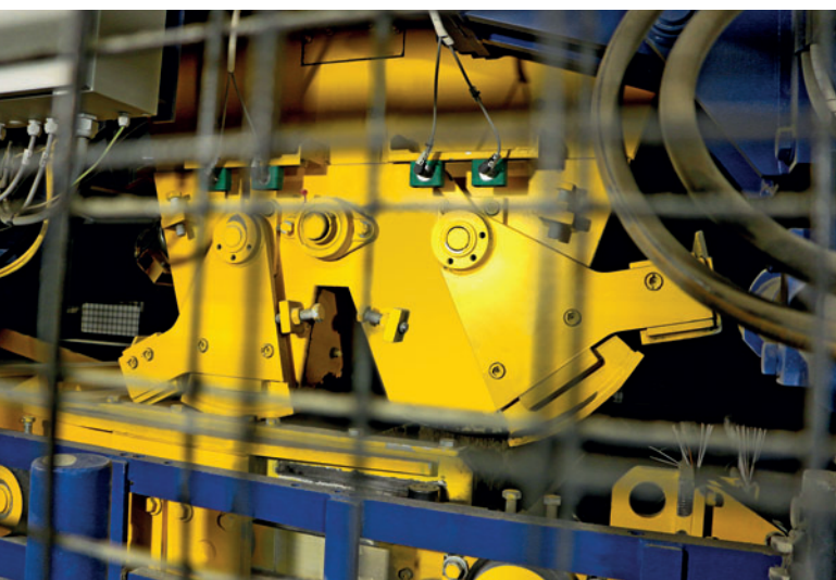
Dispositif de remplissage de béton de corps avec deux vannes de silo à commande hydraulique réglables séparément
