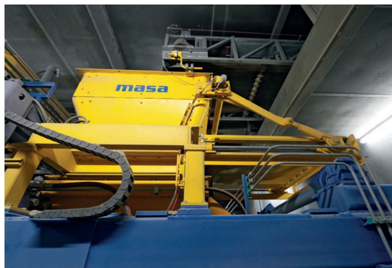
Système Multi Color avec coulisseau à commande hydraulique
