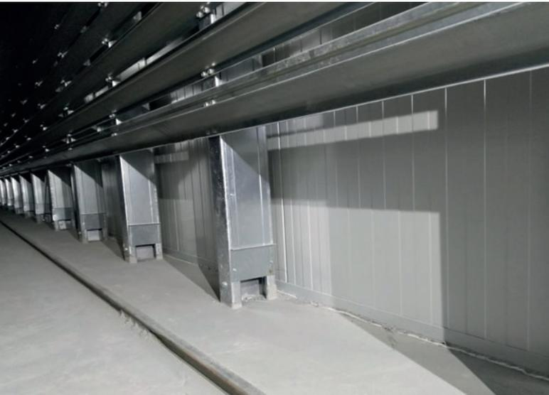
Fig. 5: En intégrant toutes les colonnes au mur de la chambre, le rayonnage Kraft décale le point de rosée de la dalle de sol vers l'extérieur, évitant ainsi la condensation d'eau et la corrosion. (Photo: Kraft Curing Systems)
