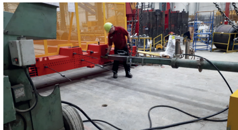
Banc de précontrainte universel à contrainte automatique de 2,7 m x 34 m avec capacité de précontrainte de 560 t
