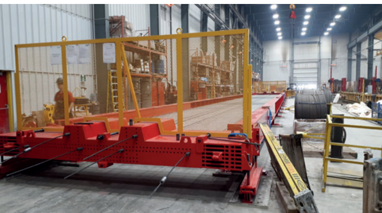
Banc de précontrainte universel à contrainte automatique de 2,7 m x 34 m avec capacité de précontrainte de 560 t
