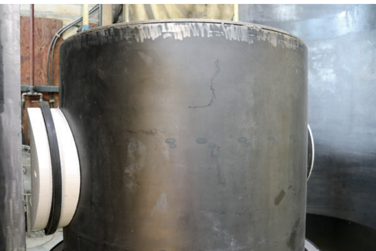
Los cuerpos negativos de las conexiones para tubos con junta integrada también se pueden colocar directamente en el núcleo de acero de los moldes.
