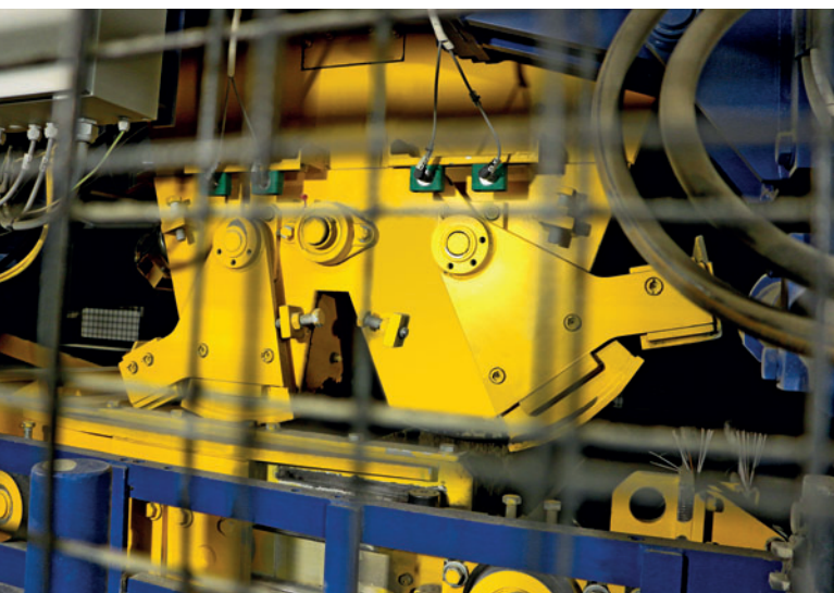
Elemento de llenado de hormigón grueso con dos compuertas de silo accionadas hidráulicamente y controlables por separado
