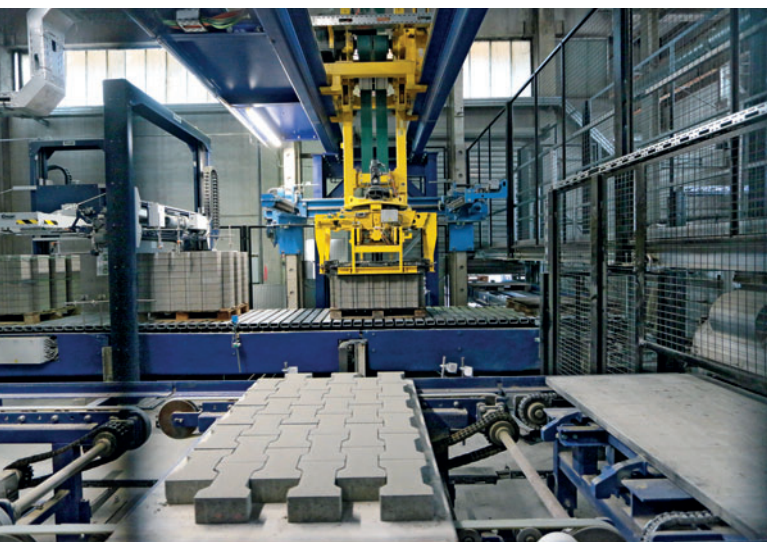
Nuevos componentes para la zona de paletizado y el transporte transversal
