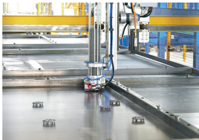
Eder logra grandes ahorros gracias a la colocación completamente automática de espaciadores con la MeshSpacer.
