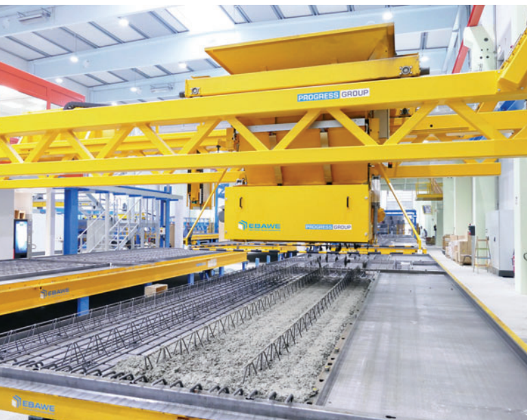
Alta velocidad de descarga en combinación con una excelente capacidad de dosificación de hormigón gracias al nuevo distribuidor automático de hormigón eCon® Drive
