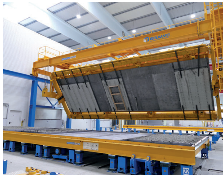
Además de prelosas armadas, Eder también fabrica muros dobles con y sin aislamiento - el ergonómico equipo de volteo se encarga del proceso de giro.
