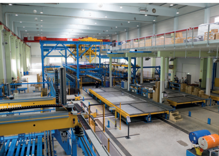
Vista de la nueva instalación de circulación altamente automatizada de Systembau Eder en Kallham
