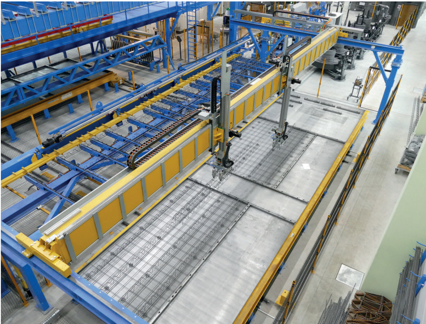
Un robot lineal multieje completa la zona de armadura automatizada de la nueva planta de Eder.
