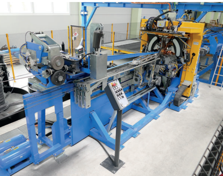
Con la soldadora de armaduras de celosía VGA Versa altamente flexible, las armaduras de celosía se producen «justo a tiempo», lo que permite a Eder lograr un alto potencial de ahorro en logística, con costes de almacenamiento y residuos reducidos.
