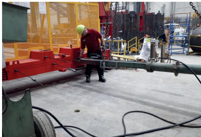
*Pista de pretensado universal auto-resistente de 2,7 m x 34 m con una capacidad de pretensado de 560 t*
