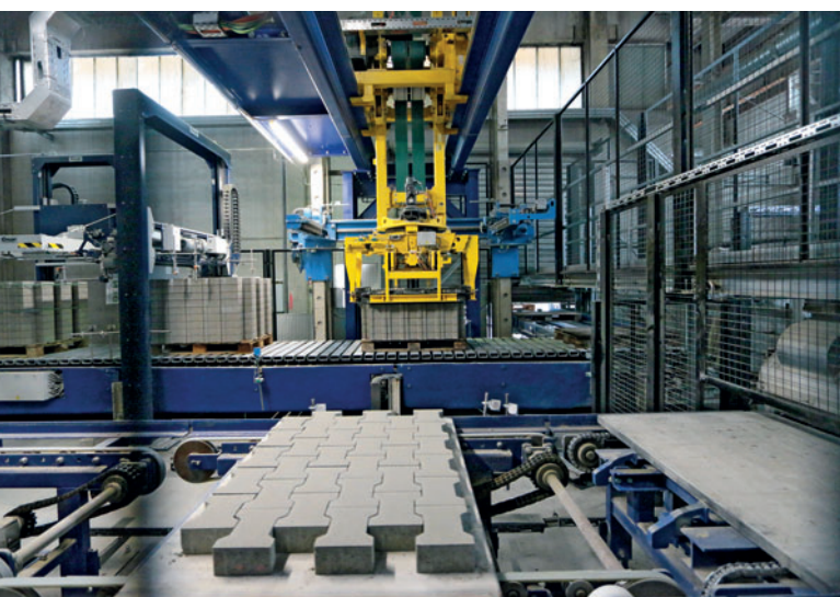
Neue Komponenten für den Paketierungsbereich und den Quertransport
