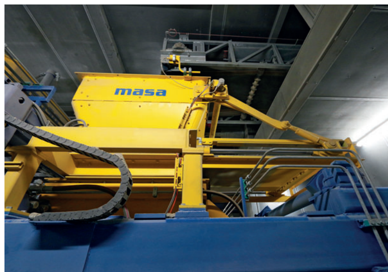
Multi-Color-Vorrichtung mit hydraulisch angetriebenem Schieber
