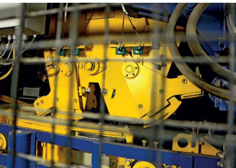
Kernfüllteil mit zwei separat regelbaren, hydraulisch angetriebenen Siloklappen
