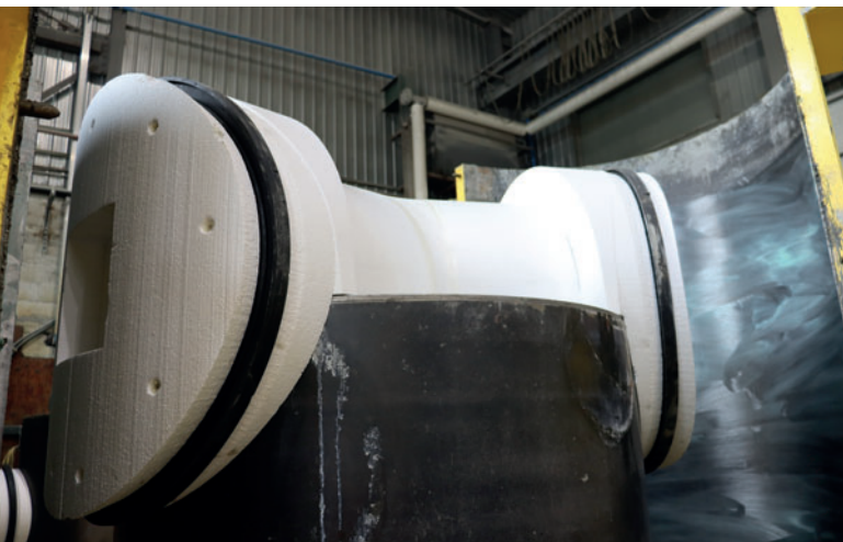
Die fertigen Negativgerinne werden mittels Magnettechnik fixiert.
