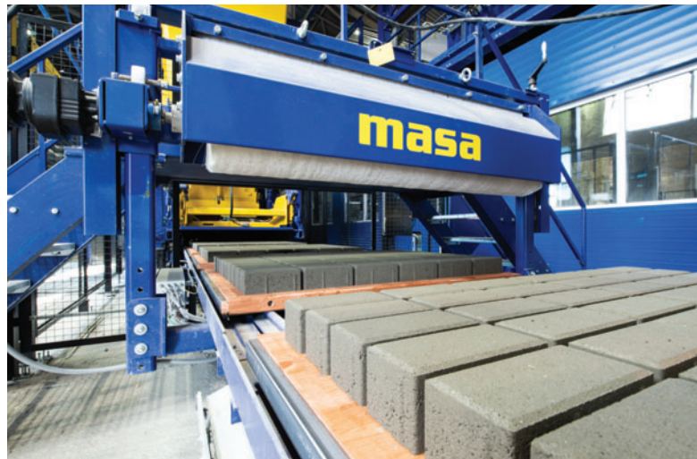
Свежеизготовленные бетонные блоки
