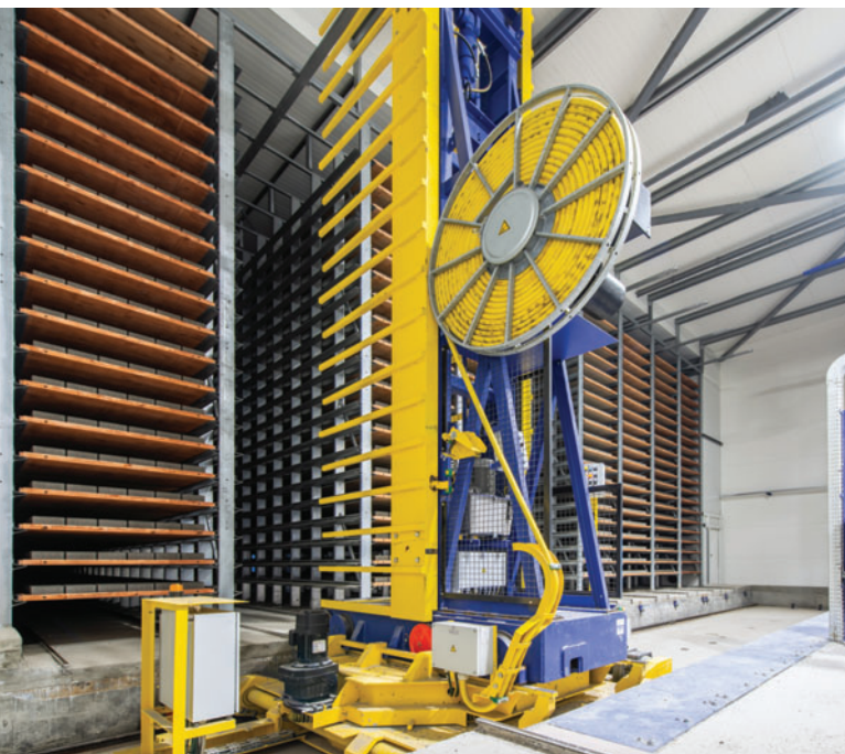
Погрузка и выгрузка бетонных блоков в камерах выдержки
