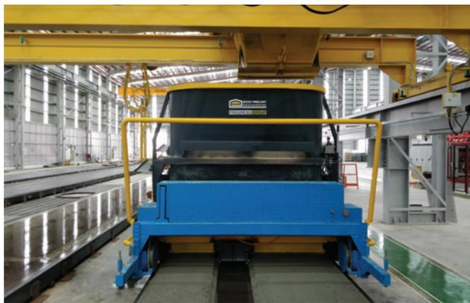
Возможность параллельного производства 2 плит разной ширины (0,8 м и 1,20 м) подчеркивает универсальность slipформера S-Liner
