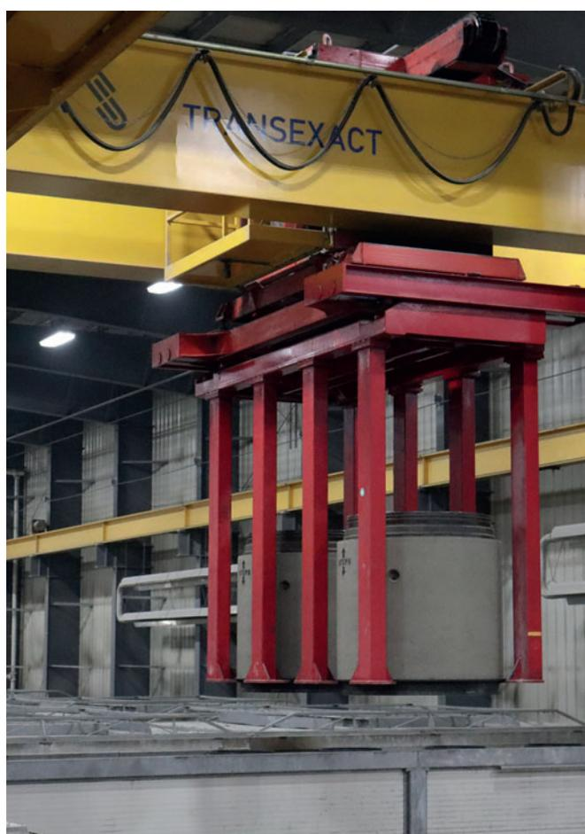
Successo anche in ciclo continuo: Schlüsselbauer Exact macchina per componenti per pozzetti e tubi
