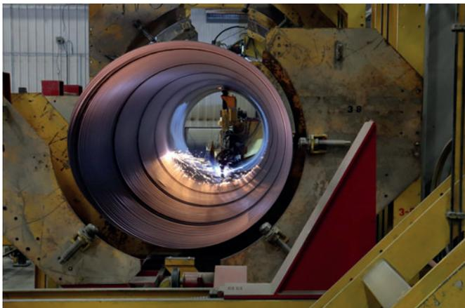
*In primo luogo, viene realizzato un cilindro di acciaio continuo partendo da una lamiera di acciaio da bobina per mezzo di saldatrici a spirale e attrezzature di stampaggio.*
