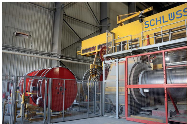
La macchina di precompressione ad alta velocità della Schlüsselbauer Technology è stata integrata nella linea di produzione come una importante miglioria del processo.
