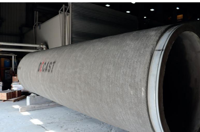
*Tubo precompresso finito al controllo qualità*
