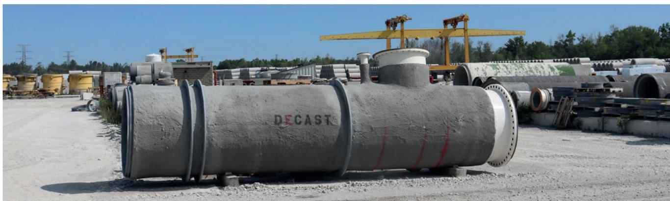
Dal 2003, Decast produce anche tubi in calcestruzzo precompressi per l'approvvigionamento di acqua potabile
